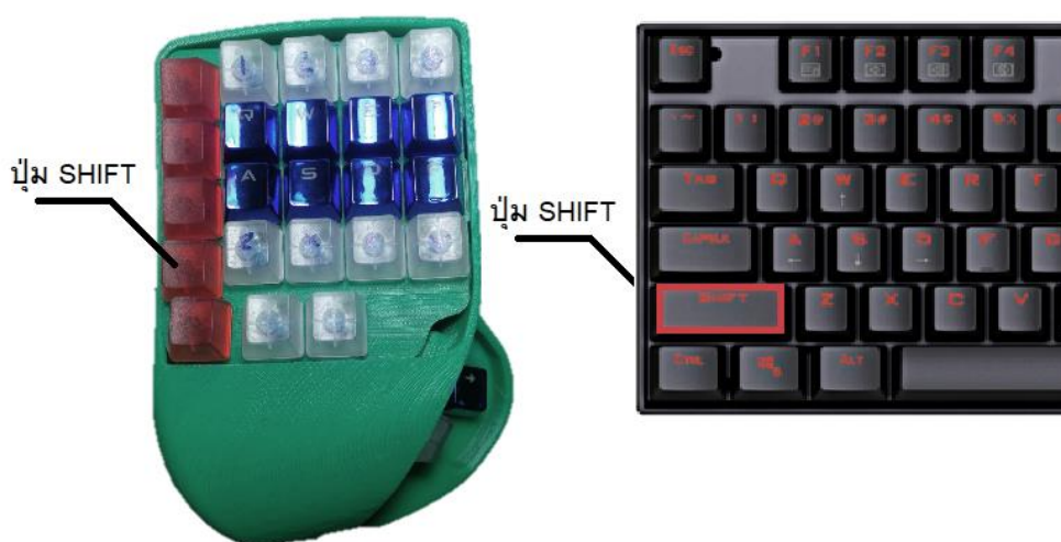
รูปที่ 4.4 ปุ่ม Shift ของแป้นพิมพ์งานวิจัยเทียบกับขนาดปุ่ม Shift ของแป้นมาตรฐาน
