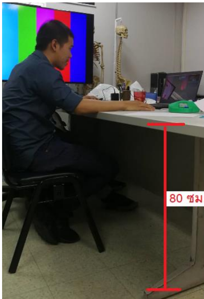
รูปที่ 3.15 ความสูงมาตรฐานโต๊ะสถานที่ทดสอบและท่าทางการนั่งทดสอบ
