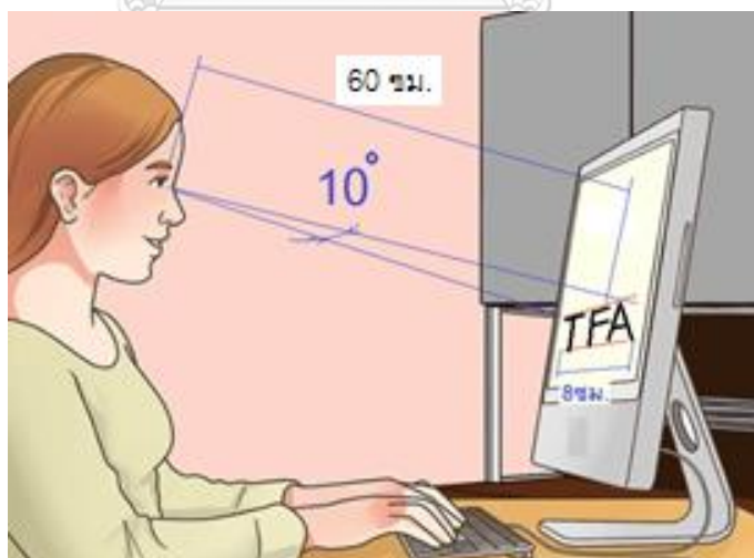
รูปที่ 3.14 ระยะห่างระหว่างตาของผู้ทดสอบถึงหน้าจอ
