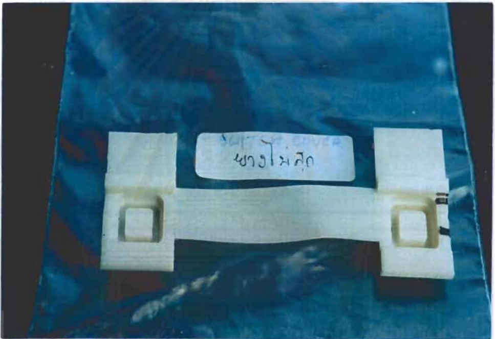
รูปที่ 5-12 แสดงปัญหาผลิตภัณฑ์ไม่สุก / เสียวรูป (47-PS0267 ; SWITCH COVER)
