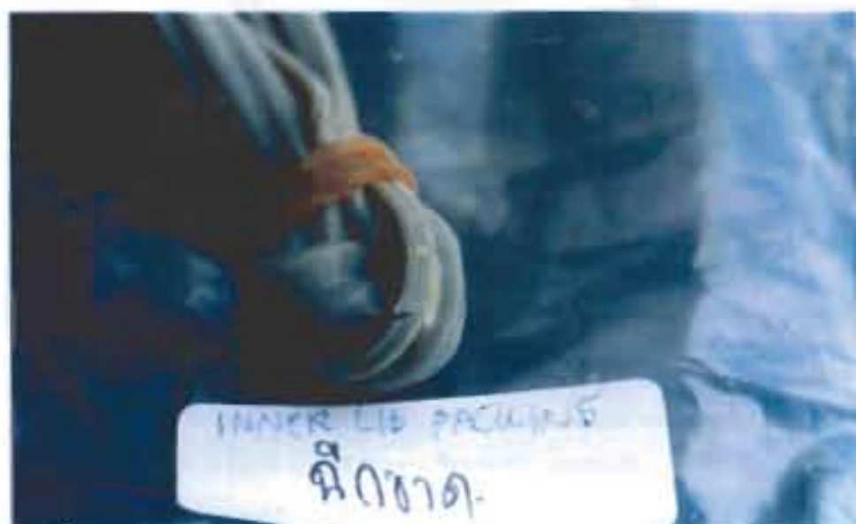
รูปที่ 5-6 แสดงปัญหาการเกิดก้นฉีกขาด (21A206 : INNER LID PACKING)
