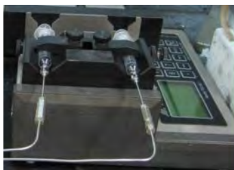
รูปที่ 3.6 เครื่องปั๊มสารประกอบเบนซีนและน้ำ
