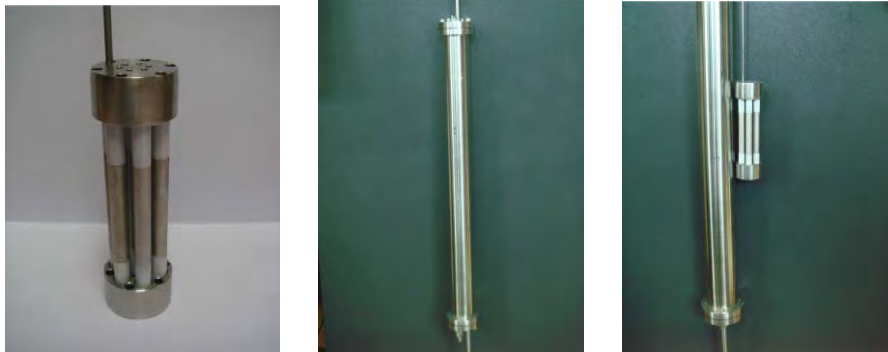
รูปที่ 3.4 แท่นรองรับตัวเร่งปฏิกิริยาแพลเลเดียม และเตปฏิกิริกรณ์แบบท่อ
