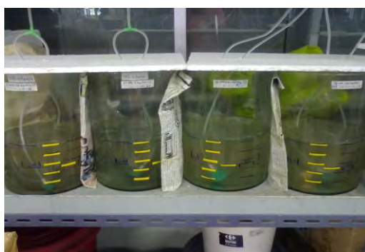
ภาพที่ 3.2 ถังปฏิกรณ์แบบแบทช์ที่ใช้ในการทดลอง
