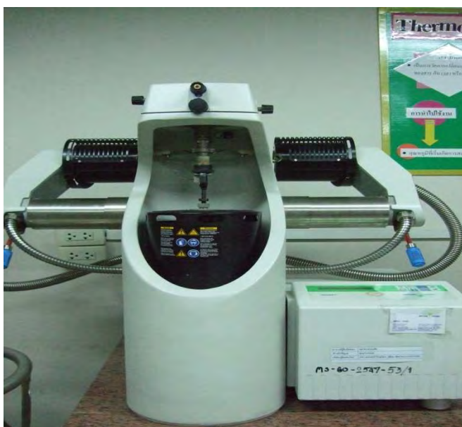
รูปที่ 3.17 เครื่อง Dynamic mechanical analyzer ของ METTLER TOLEDO รุ่น 861°
