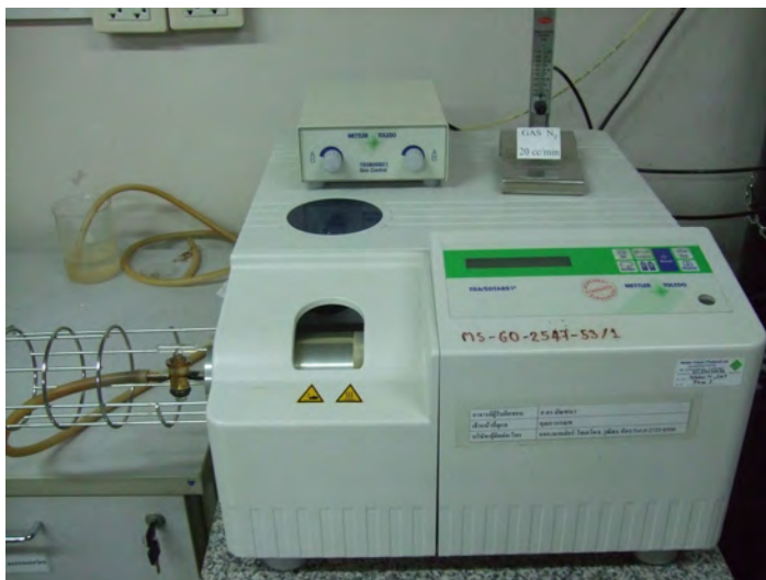
รูปที่ 3.16 เครื่อง Thermogravimetric analyzer ของ METTLER TOLEDO รุ่น TGA/SDTA 851°
