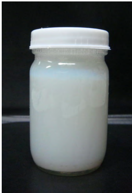
รูปที่ 4.1 พอลิสไตรีนนาโนเลเท็กซ์ที่สังเคราะห์ได้จากกระบวนการเกิดพอลิเมอร์แบบดิฟเฟอเรนเชียลไมโครอิมัลชัน
