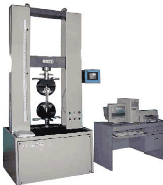
รูปที่ 3.14 เครื่อง Universal Testing Machine รุ่น LLOYD LR 100K
