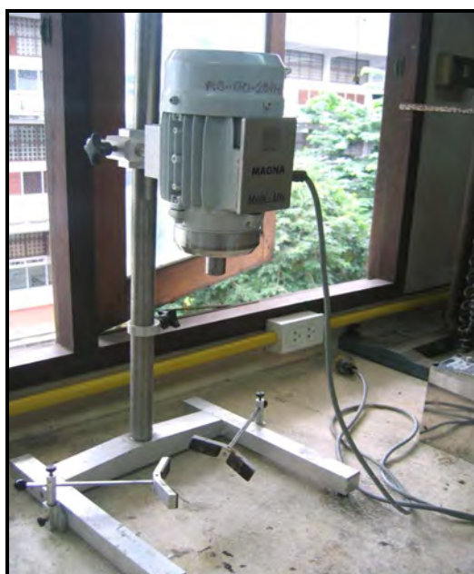
รูปที่ 3.10 เครื่องปั่นความเร็วสูง (high speed mixer)
