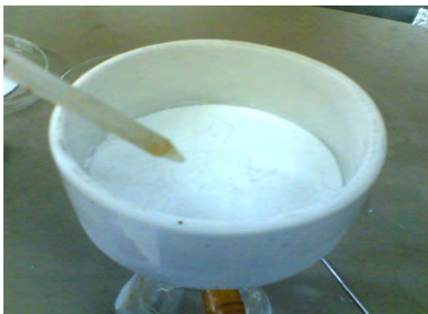
รูปที่ 3.4 การล้างและกรองอนุภาคนาโนเมตรที่เตรียมได้ด้วยเครื่องกรองสุญญากาศ
