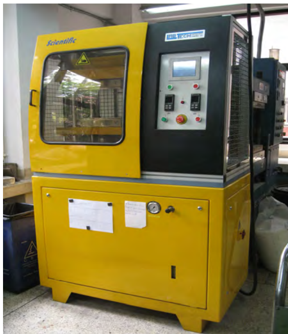
รูปที่ 3.12 เครื่องอัดแบบ (compression molding machine) ของบริษัท LAB TECH จำกัด
