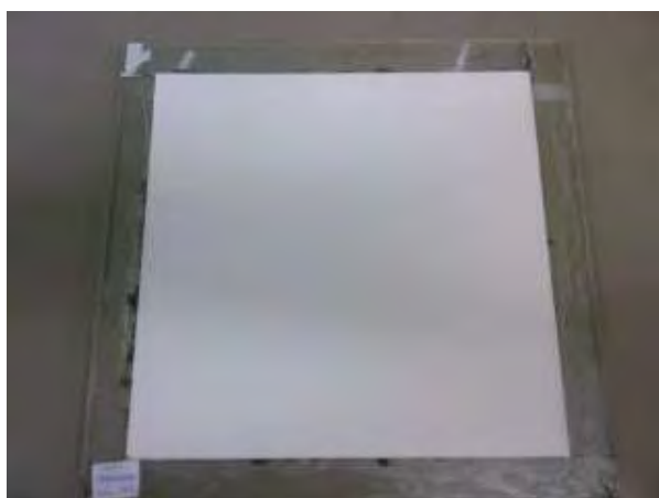
รูปที่ 3.11 แม่พิมพ์ที่ทำจากแผ่นกระดาษขนาด 20 \times 20 \times 0.15 เซนติเมตร
