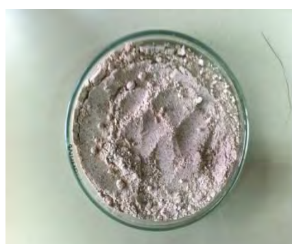
รูปที่ 4.2 เมล็ดข้าวฟ่างที่ผ่านการทำความสะอาด อบแห้ง และบดผ่านตะแกรงร่อน 400 ไมครอน
