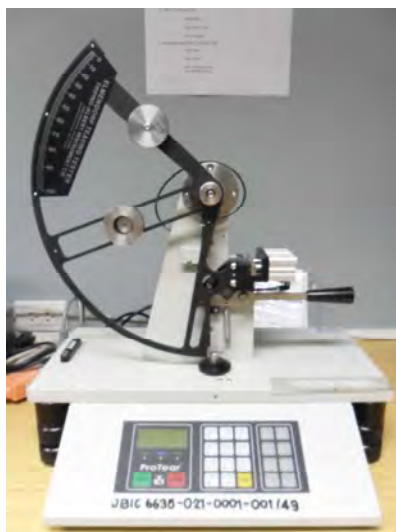
ภาพที่ 3-10 เครื่องวัดความต้านทานแรงฉีก (Elmendorf tearing resistance tester)
