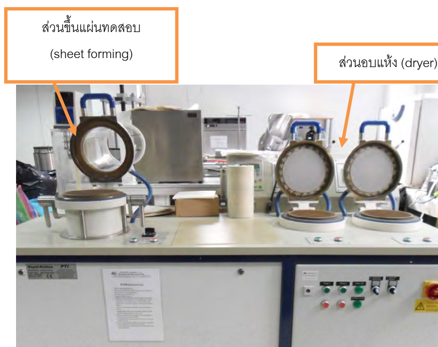
ภาพที่ 3-5 เครื่องขึ้นแผ่นทดสอบ (Rapid-Kothen sheet former)
