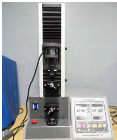
ภาพที่ 3-8 เครื่องวัดความแข็งแรงต่อแรงดึง (tensile strength tester)
