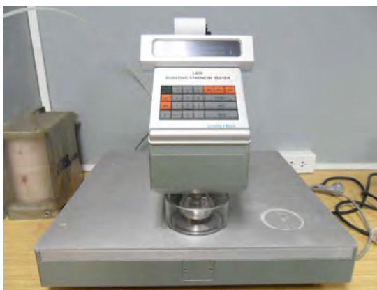
ภาพที่ 3-9 เครื่องวัดความแข็งแรงต่อแรงดันทะลุ (burst strength tester)
