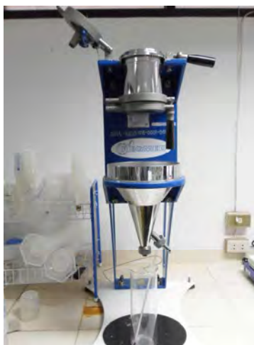
ภาพที่ 3-3 เครื่องวัดค่าสภาพระบายได้ของเยื่อ (freeness tester)
