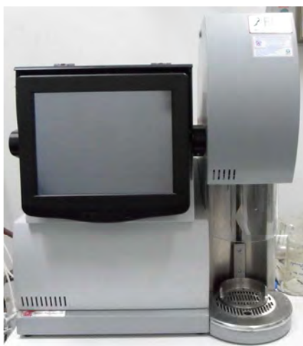
ภาพที่ 3-4 เครื่องวิเคราะห์เส้นใย (Fiber Quality Analyzer; FQA)
