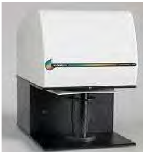
ภาพที่ 3-7 เครื่องวัดสมบัติเชิงแสงของแผ่นทดสอบ (Color touch PC)
