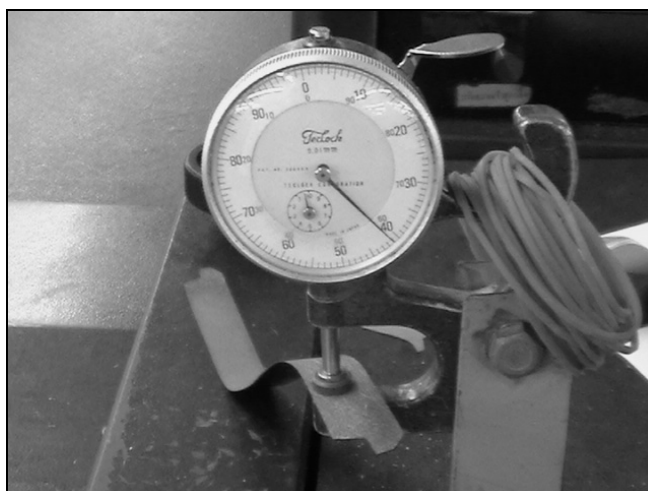
รูปที่ ก-5 การวัดความหนาของเศษหนังที่ล่องทำการผ่า
