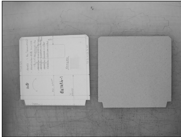
รูปที่ 4.2 แม่แบบในการทำงาน (ทางซ้าย) และไบมัด (ทางขวา)
