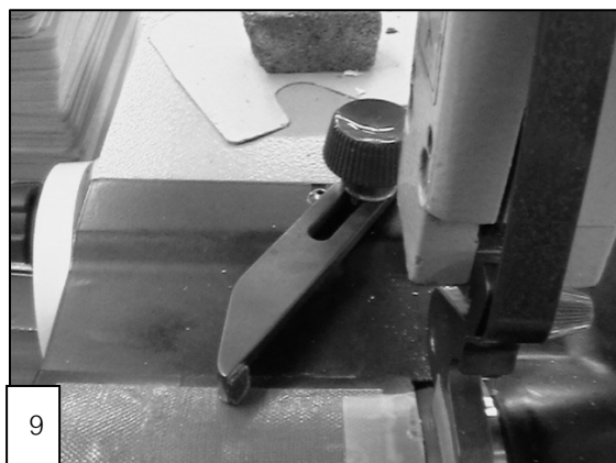
รูปที่ ก-7 ขั้นตอนการประกอบตีนผีเข้ากับเครื่องเย็บ
