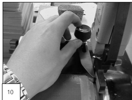
รูปที่ ก-7 ขั้นตอนการประกอบตีนผีเข้ากับเครื่องเย็บ
