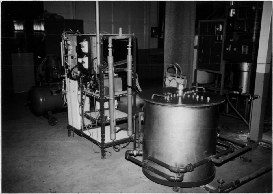
รูปที่ 2.5 แสดงเครื่องปฏิกรณ์ชีวภาพแบบตรึงชั้นและระบบควบคุมต่าง ๆ
