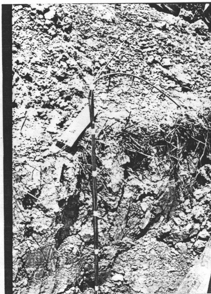
การติดตั้งสายวัดอุณหภูมิดินเพื่อวัดอุณหภูมิดินที่ระดับความลึก 30, 70 และ 110 เซนติเมตร
