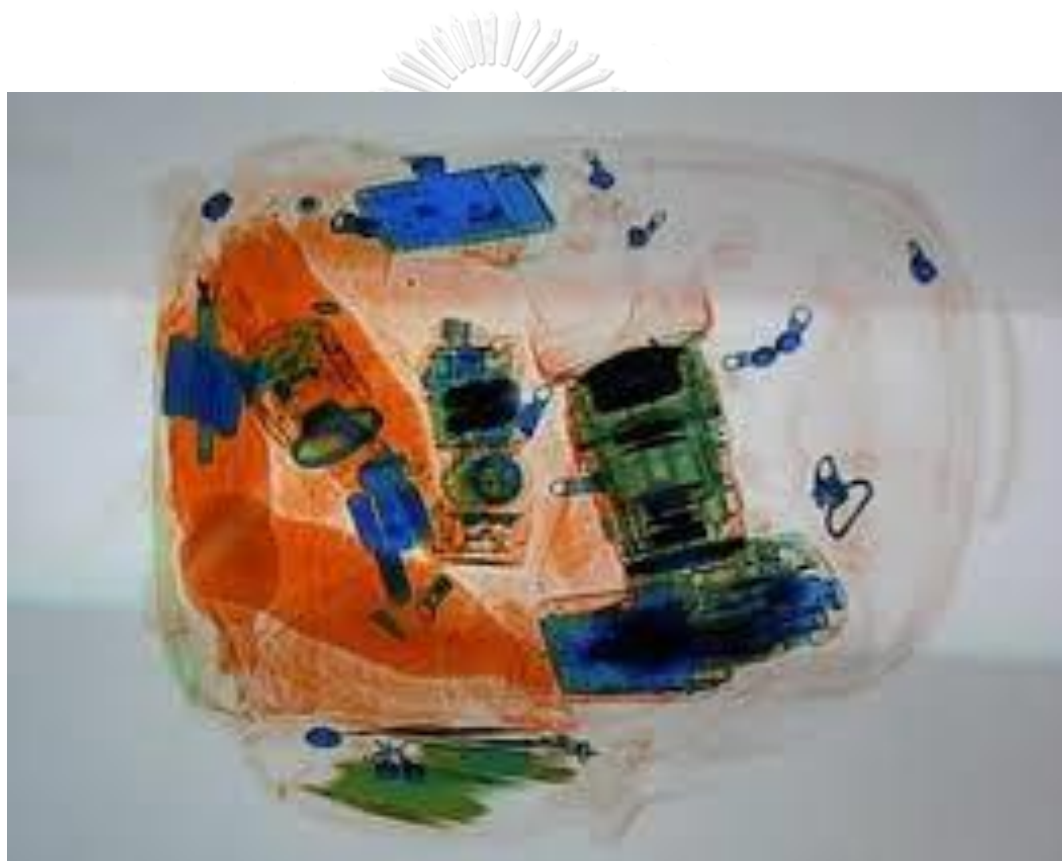
ภาพที่ 4.9 ภาพการสแกนกระเป๋าด้วยรังสีเอกซ์
