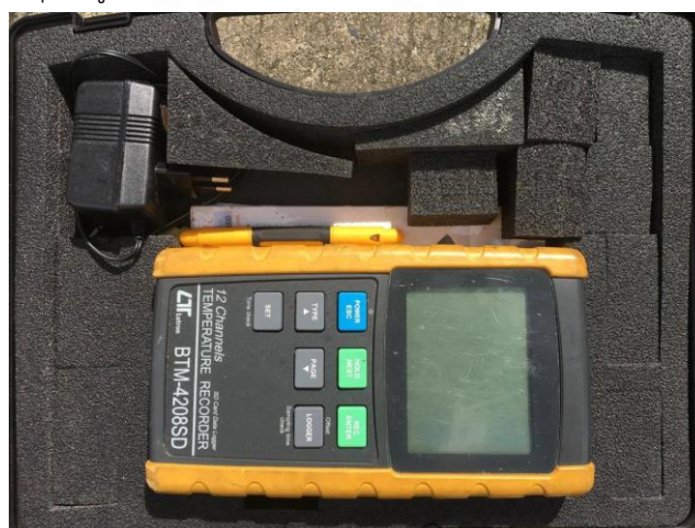
รูปที่ 3.2 อุปกรณ์การวัดอุณหภูมิ 12 Channels Temperature Recorder
