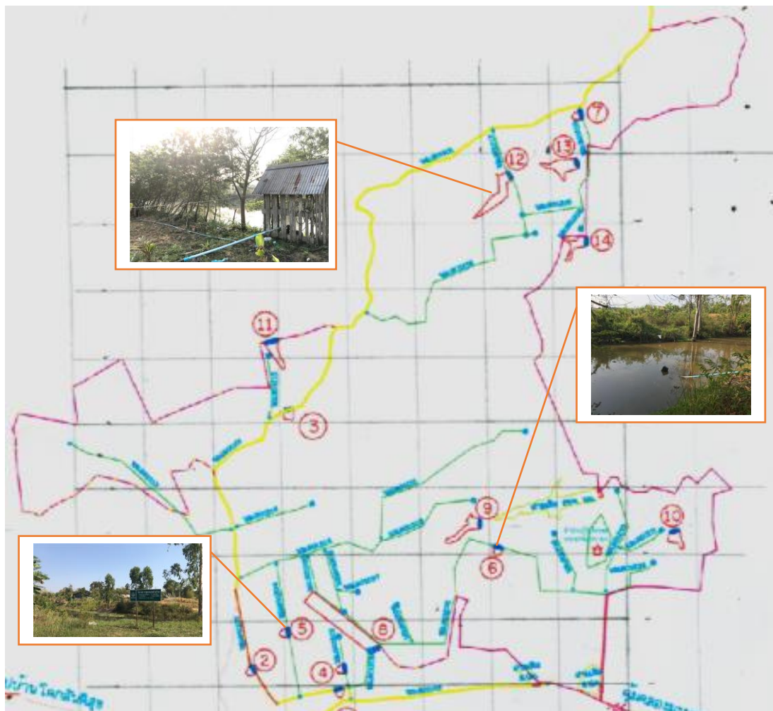
ภาพที่ 4-12 แผนผังตำแหน่งฝายหรือทำนบดินเพื่อกักเก็บน้ำของโครงการนิคมเศรษฐกิจพอเพียง อำเภอวังน้ำเขียว
