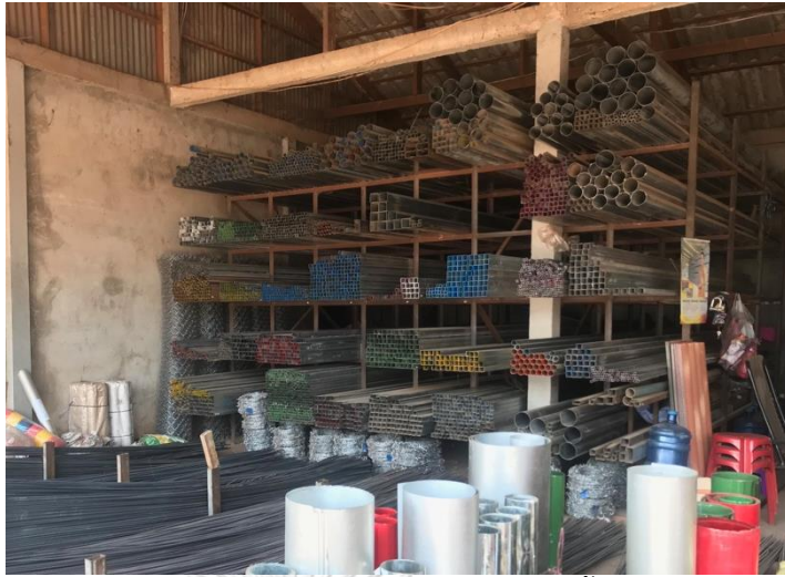
ภาพที่ 12 เหล็กรูปพรรณรีดเย็นที่มีขายในพื้นที่
