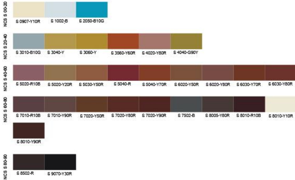
รูปที่ 3.22 สีที่ได้จากการสำรวจองค์ประกอบบานกรอบประตู อาคารประเภทบ้าน เมืองเก่าบ้าน
