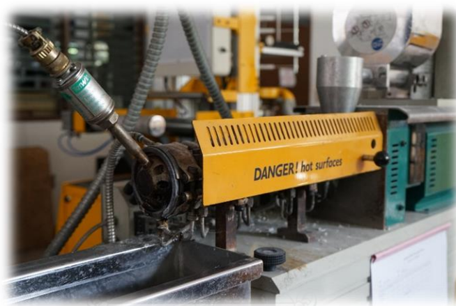
รูปที่ 3.2 เครื่องอัดรีดสกรูคู่ (twin-screw extruder) รุ่น Prism DSR-28
