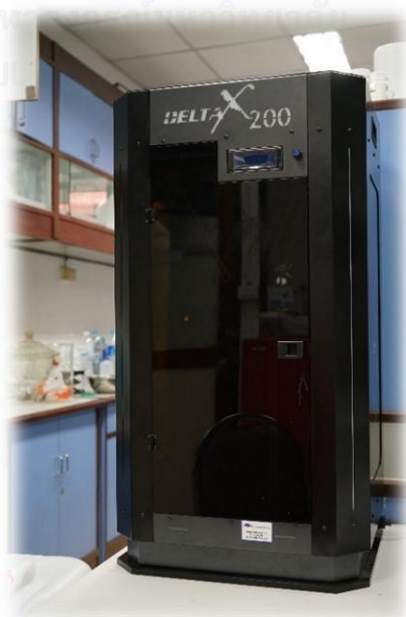
รูปที่ 3.4 เครื่องพิมพ์สามมิติแบบ FDM รุ่น DeltaX200
