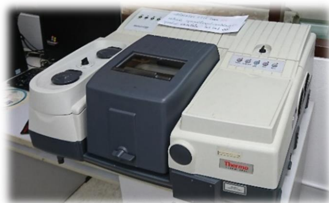
รูปที่ 3.5 เครื่องฟูเรียร์ทรานสฟอร์มอินฟราเรดสเปกโทรสโกปี (FT-IR) รุ่น Nicolet 6700
