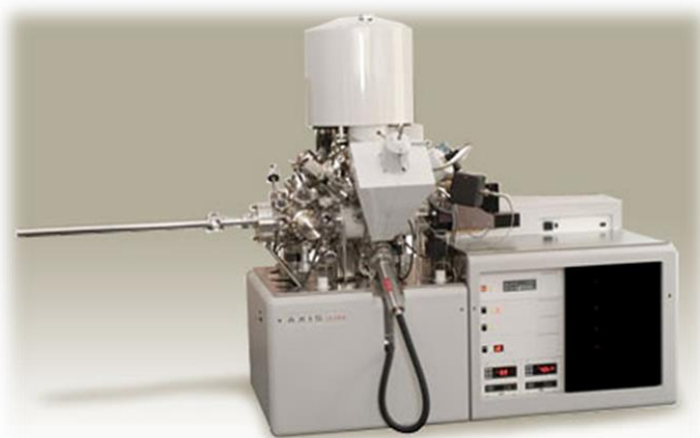
รูปที่ 3.6 เครื่องวิเคราะห์องค์ประกอบธาตุ (XPS) รุ่น AXIS Ultra DLD
