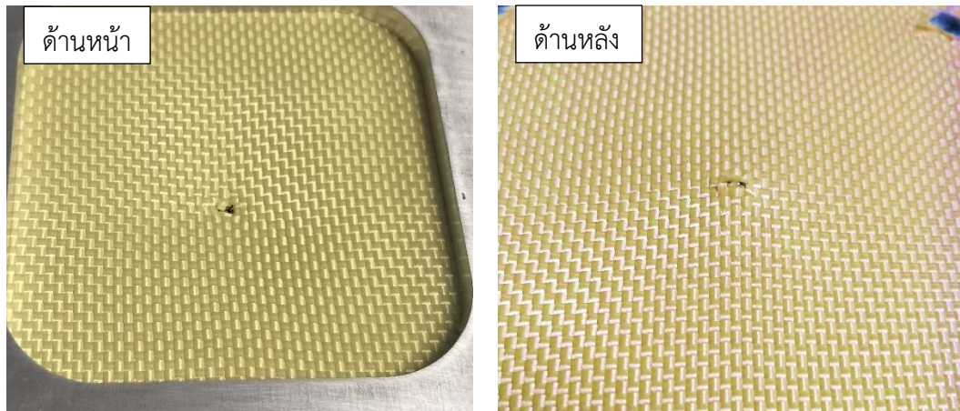
รูปที่ 1.26 ลักษณะรอยขาดของชิ้นงานสิ่งทอเคฟล่าหลังการทดสอบความต้านทานต่อการแทง
