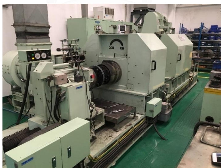
รูปที่ 3.13 เครื่องเบรกไดนาโมมิเตอร์
