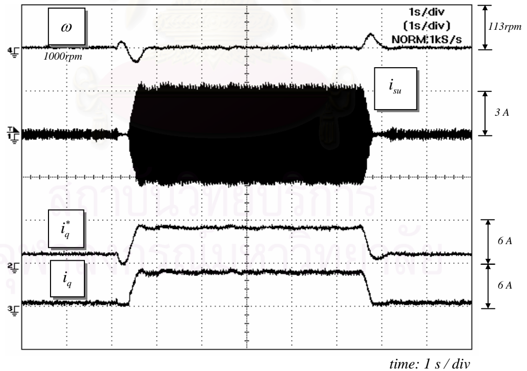
รูปที่ 3.21 ผลการทดลองในกรณีเปลี่ยนแปลงโหลดแบบขั้นที่ความเร็ว 1000 rpm เมื่อใช้การควบคุมแยกการเชื่อมร่วม
