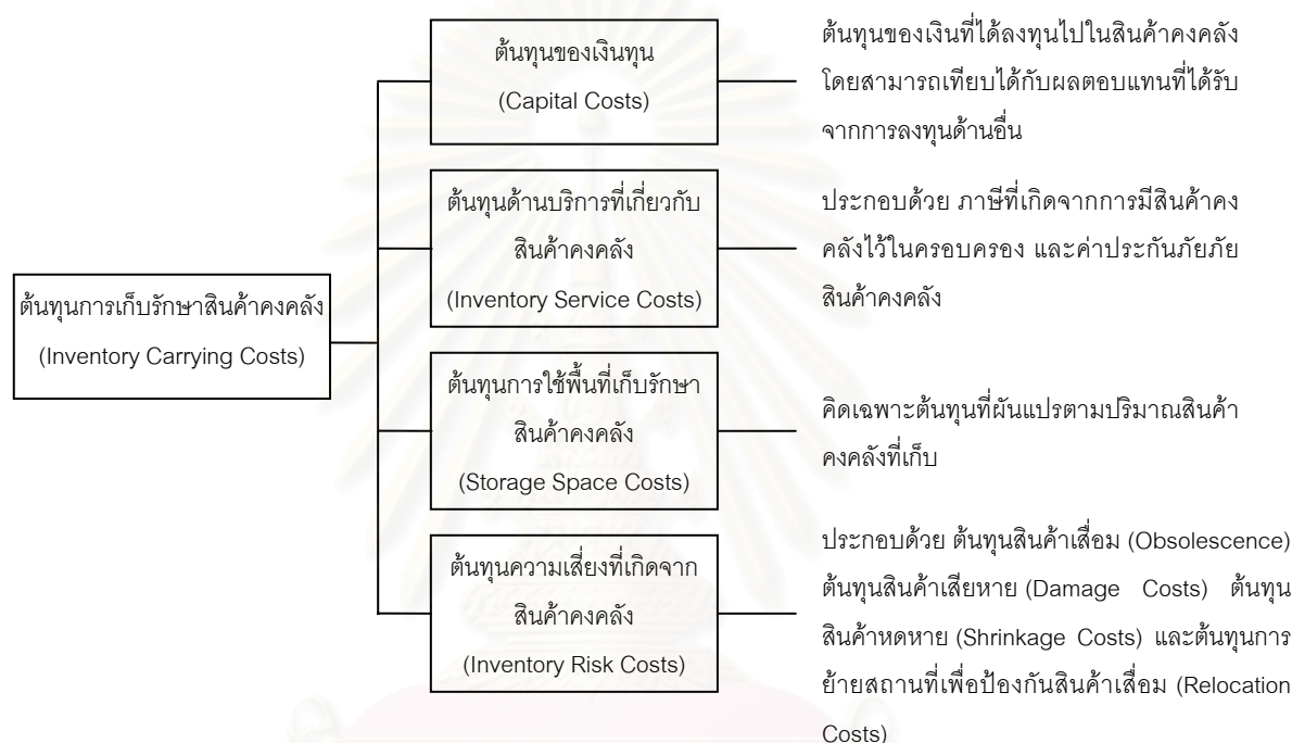
รูปที่ 4.2 แสดงส่วนประกอบของต้นทุนในการเก็บรักษาสินค้าคงคลัง
