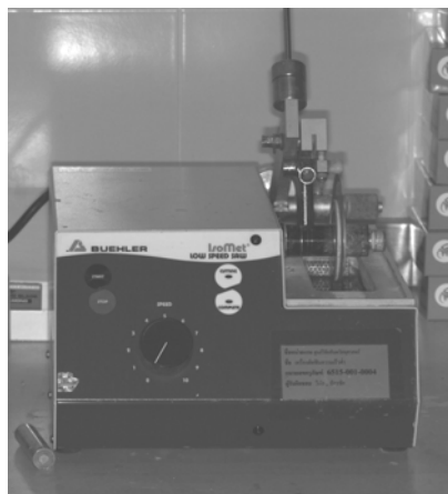
รูปที่ 5 แสดงเครื่องมือตัดความเร็วต่ำ ( low speed cutting machine)
