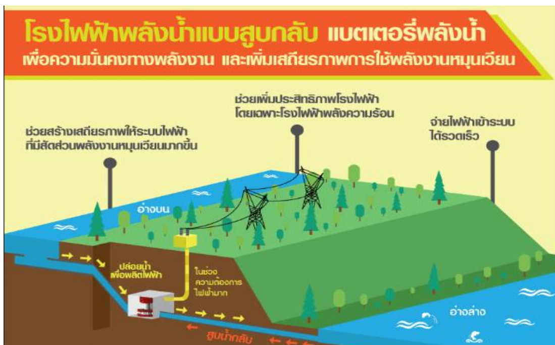
ภาพที่ 8 แผนผังแสดงหลักการทำงานของโรงไฟฟ้าพลังน้ำแบบสูบกลับ 20
