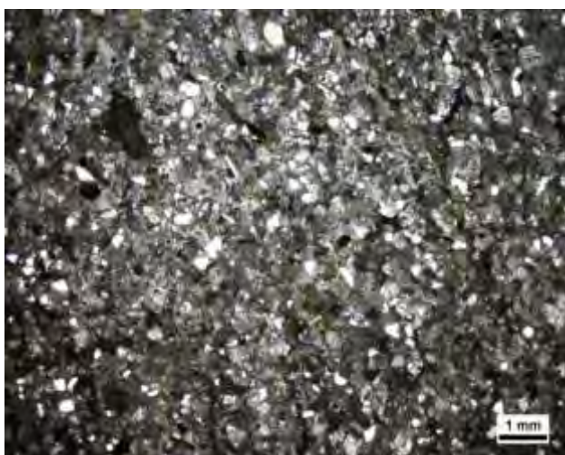
รูปที่ 2.9 ศิลาวรรณนาของหินทราย WPT 14 ที่มีลักษณะของเม็ดควอตซ์กระจายตัวอยู่ร่วมกับคาร์บอนेट โดยภาพด้านขวาจะเป็นภาพที่แสดงภายใต้แสงโพลาไรซ์
