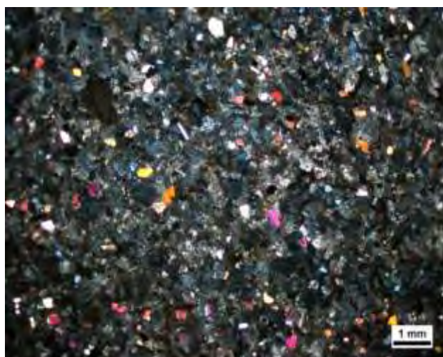
รูปที่ 2.9 ศิลาวรรณนาของหินทราย WPT 14 ที่มีลักษณะของเม็ดควอตซ์กระจายตัวอยู่ร่วมกับคาร์บอนेट โดยภาพด้านขวาจะเป็นภาพที่แสดงภายใต้แสงโพลาไรซ์
