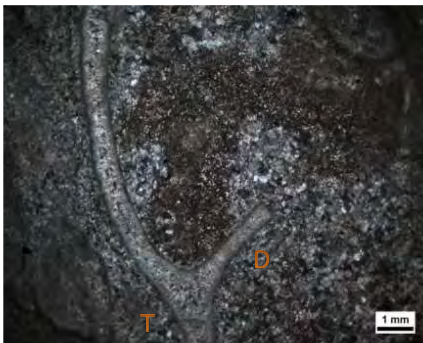
รูปที่ 2.16 ศิลาวรรณนาของหินปูน WPT 65 ภายใต้แสงโพลาไรซ์ โดยแสดงให้เห็นถึงปะการังแบบแทบูลเลต แสดงด้วยสัญลักษณ์ T และมีผลึกโดโลไมต์อยู่บริเวณด้านข้าง แสดงด้วยสัญลักษณ์ D
