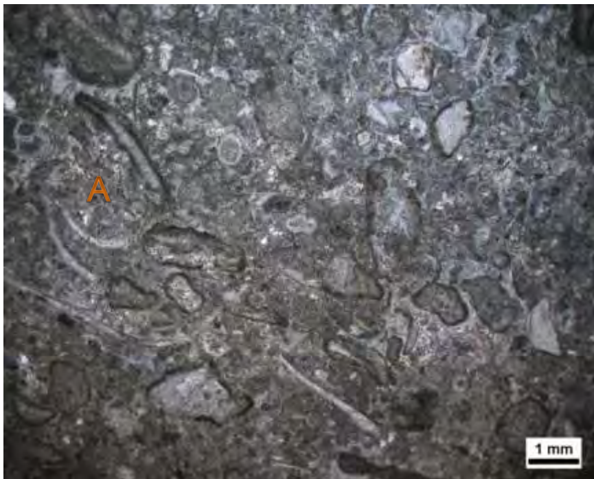
รูปที่ 2.13 ศิลาวรรณนาของหินปูน WPT 42 ที่มีลักษณะของสาหร่ายแสดงด้วยสัญลักษณ์ A และพบลักษณะของไมโครเบซิลเป็นขอบสีดำพอกอยู่บริเวณขอบผลึก
