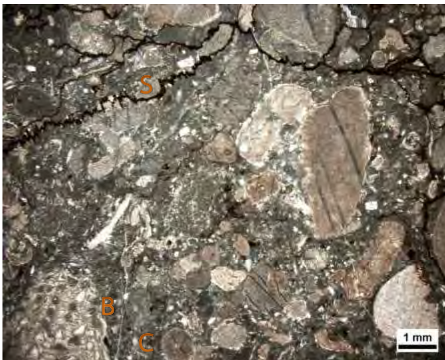
รูปที่ 2.5 ศิลาวรรณนาของหินปูน WPT 4 ที่มีซากดึกดำบรรพ์ไบรโอซัว (Bryozoa) แสดงด้วยสัญลักษณ์ B ไครนอยด์ (Crinoid) แสดงด้วยสัญลักษณ์ C และลักษณะของแนวฟันในหิน (Stylolite) แสดงด้วยสัญลักษณ์ S
