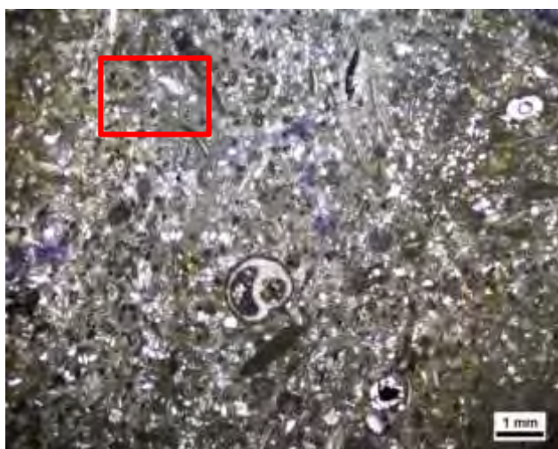
รูปที่ 2.8 ศิลาวรรณนาของหินปูน WPT 12 ที่มีลักษณะของเม็ดควอตซ์เม็ดเล็กๆกระจายตัวอยู่ภายใน โดยภาพด้านขวาจะเป็นภาพถ่ายของภาพซ้ายในบริเวณกรอบสีแดงภายใต้แสงโพลาไรซ์ จะสังเกตเห็นว่ามีลักษณะของผลึกควอตซ์ขนาดเล็กอยู่ภายใน
