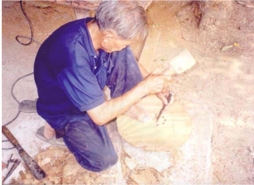
ภาพที่ 51 ใช้ค้อนตอกตีวงตามสัญลักษณ์ที่กำหนดและเชื่อมต่อวงกลม
