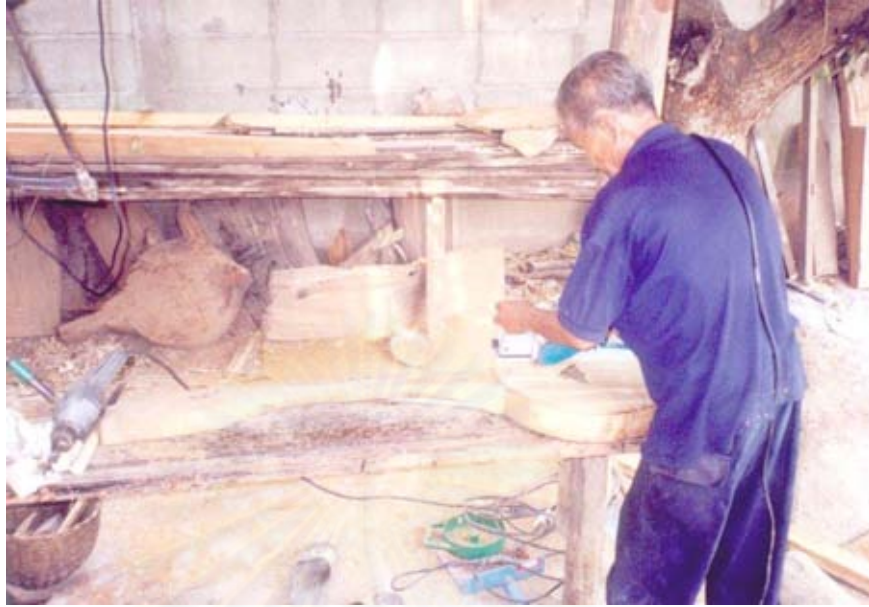
ภาพที่ 76 ใช้กบไฟฟ้าไสตาดชิง 6 สาย
