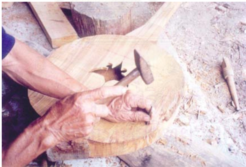
ภาพที่ 69 ตอกส่งตะปูตัวเล็กลงให้ลึก
