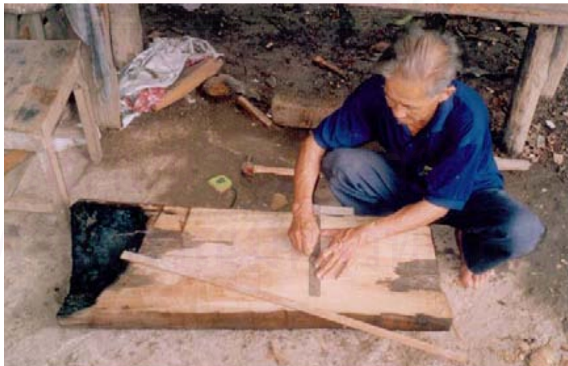
ภาพที่ 22 วัดด้วยไม้ฉาก หาจุดตัวกล่องเสียง
