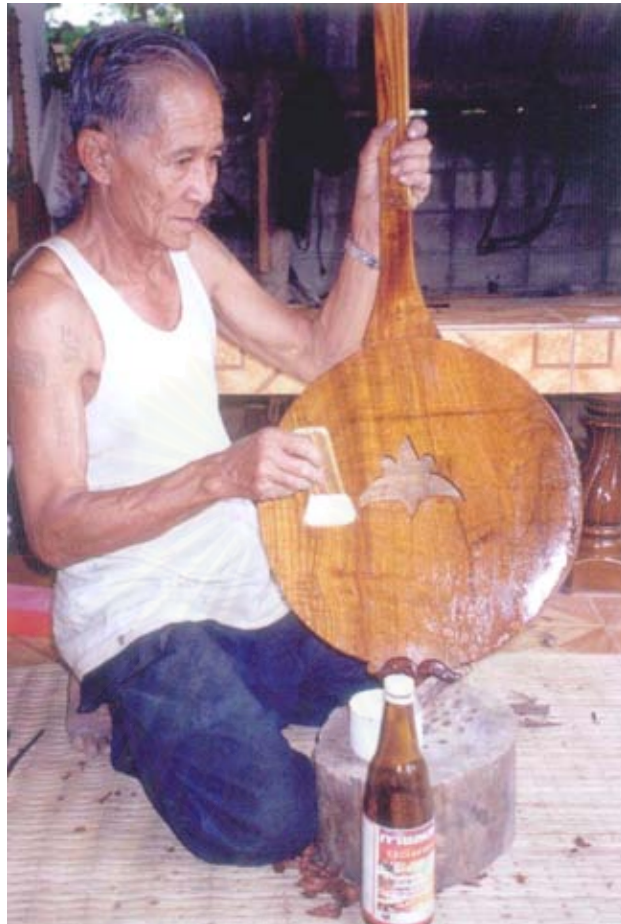
ภาพที่ 101 ทากาแลนที่ยูริเทนด้วยแปรงในลักษณะที่ทากั้น
