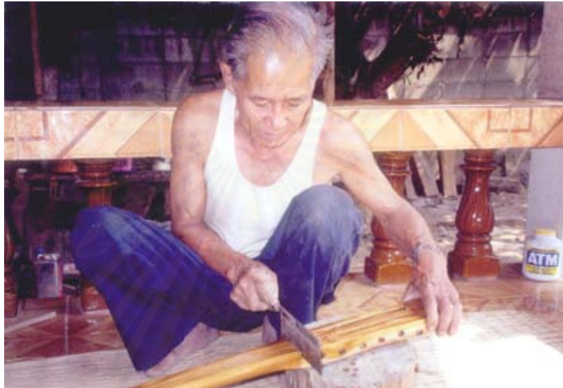
ภาพที่ 83 ใช้เลื่อยขนาดเล็กทำก๊อบหน้า
