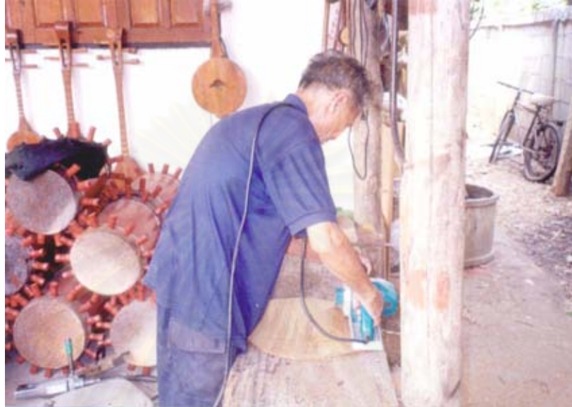
ภาพ 45 ใช้กบไฟฟ้าสไลอีกด้านของตาดชิง 6 สาย
