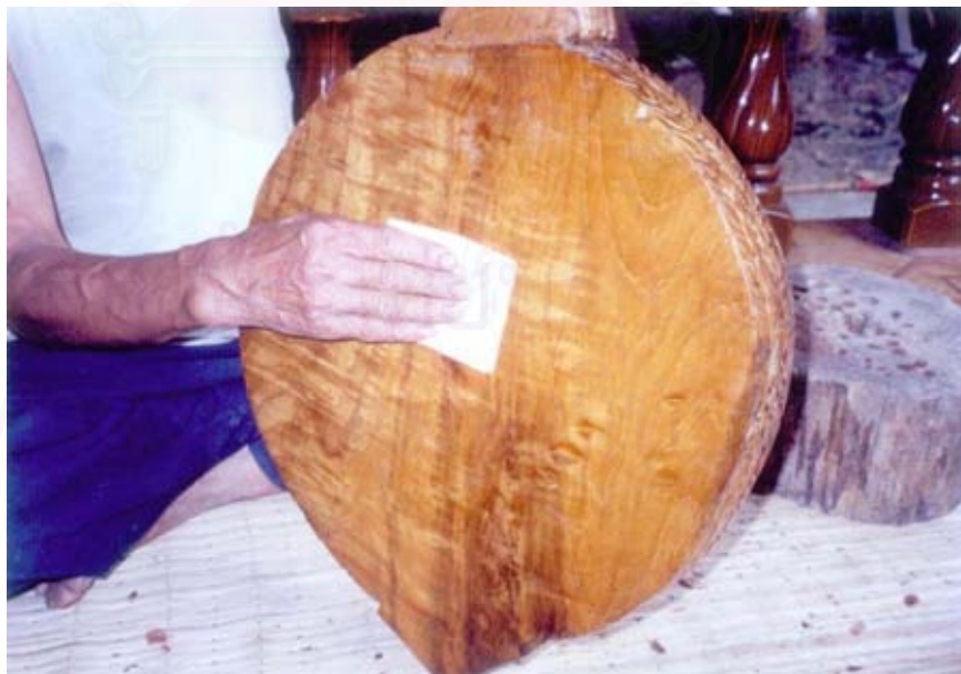
ภาพที่ 98 ขัดด้วยกระดาษทรายเพื่อเตรียมชักเงาเนื้อไม้
