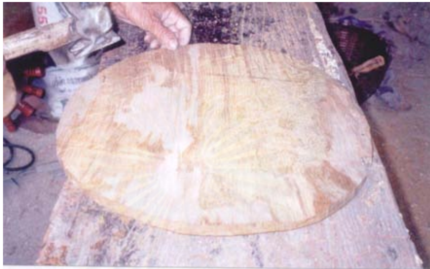
ภาพ 41 ตาดของชิง 6 สายที่ได้รูปทรงแล้ว
