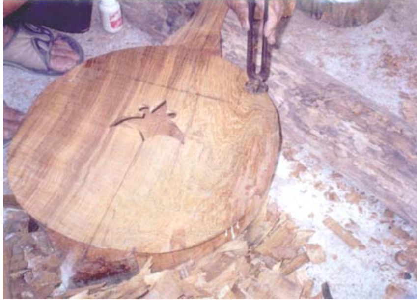
ภาพที่ 68 ใช้คีมตัดหัวตะปูที่ตอกไว้ทุกเล่ม
