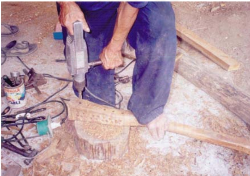
ภาพที่ 81 ใช้สว่านไฟฟ้าเจาะรูทั้ง 6 รู
