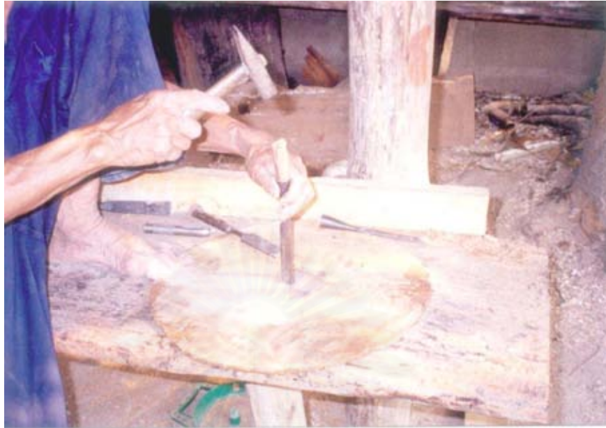
ภาพที่ 55 ใช้ลิ่วแต่งในส่วนที่ปอกและหาง
