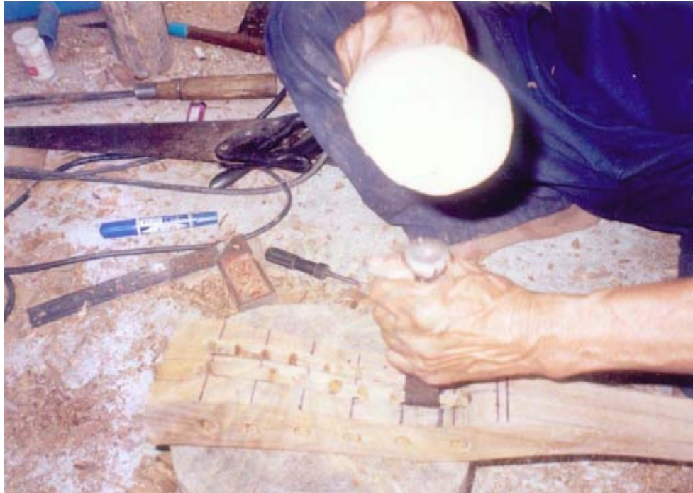
ภาพที่ 82 ใช้ก้อนไม้ตอกตีทำช่องหัวซึ่ง 6 สาย
