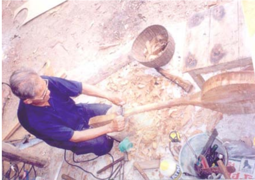
ภาพที่ 74 ใช้กบปิ้งไม้แต่งคอซิ้ง
