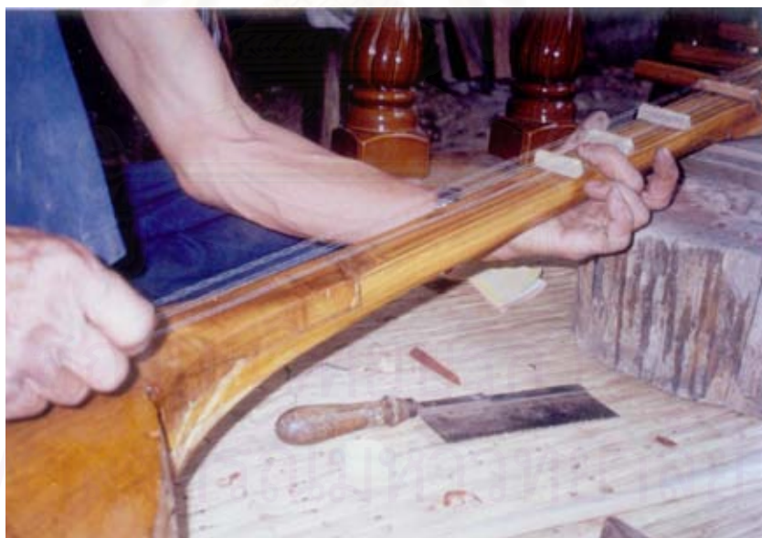
ภาพที่ 113 ตัดลูกนับอันที่ 3
