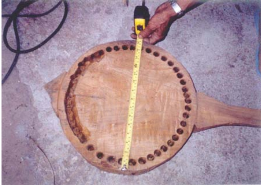
ภาพ 31 วัดด้วยตลับเมตรเพื่อหามอกหรือสูตรการผลิตซิ่ง 6 สาย
