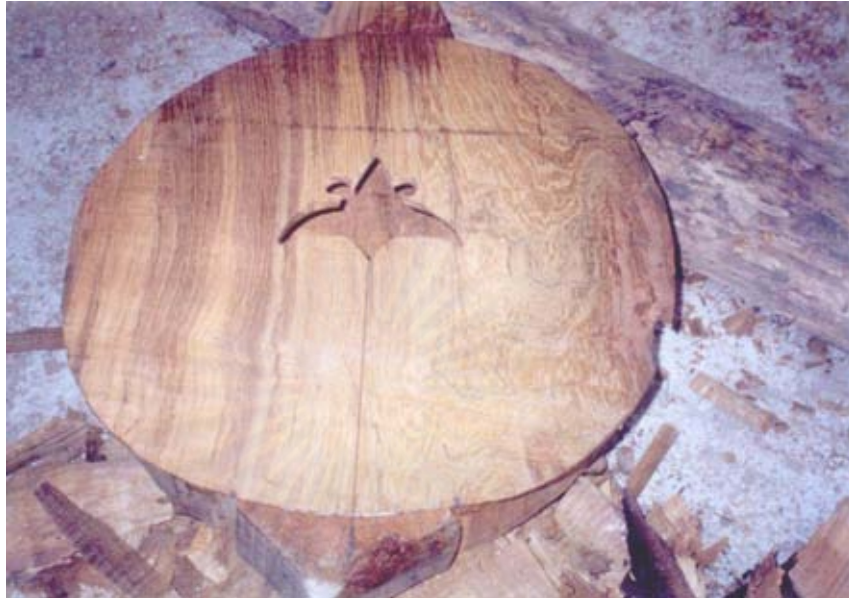
ภาพที่ 66 ติดประกบระหว่างตาดกับตัวกลองเสียงซิ้ง 6 สาย
