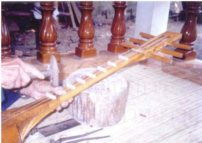
ภาพที่ 119 ติดลูกนับอันที่ 8
