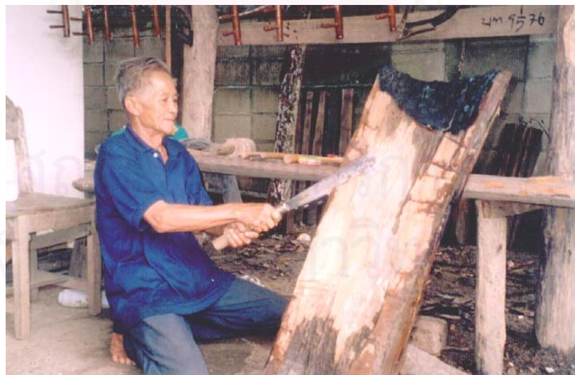
ภาพที่ 20 ใช้มีดตากด้านซ้ายของไม้
