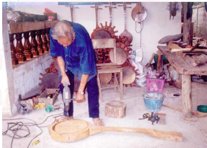
ภาพ 29 เเจาะตัวกล่องเสียงซึ่งด้วยส่วานไฟฟ้า
