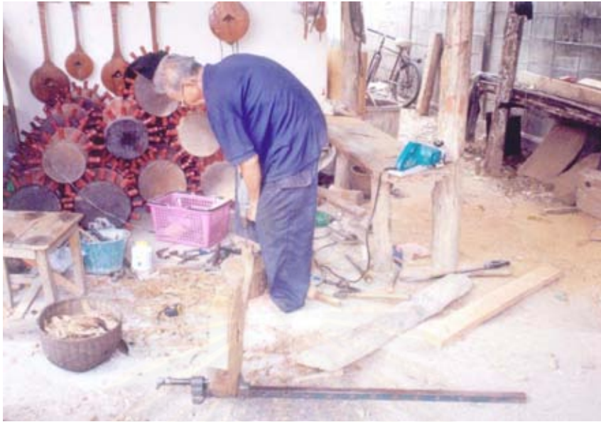
ภาพที่ 80 เจาะรูหัวซึ่งด้านที่ใส่ลูกบิด
