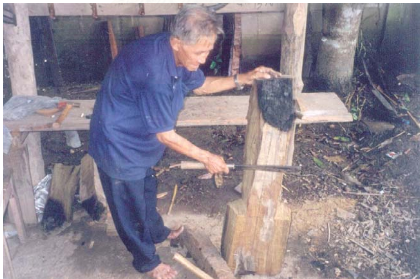
ภาพที่ 26 มีดถากจากด้านบนลงสู่ตัวกล่องเสียง
