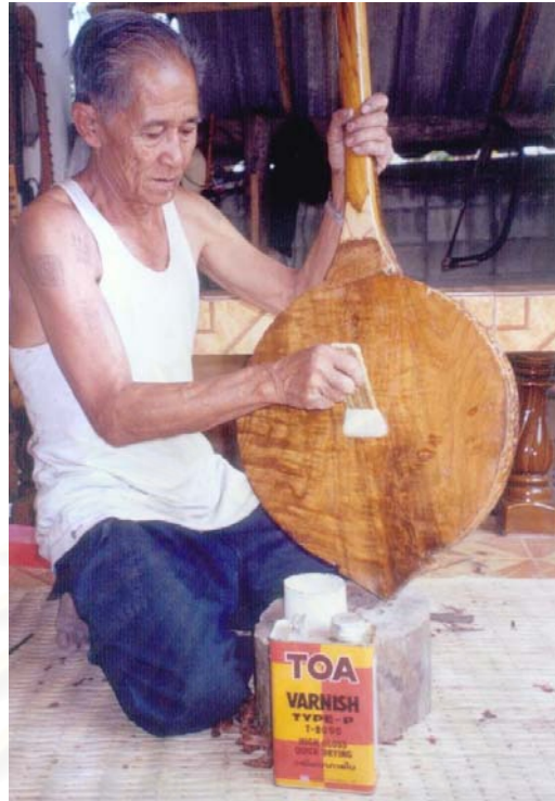
ภาพที่ 99 ทาวนิชเงาด้วยแปรงในลักษณะที่ทาจันด้านหลัง
