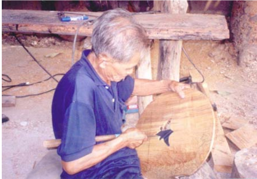
ภาพที่ 57 แสดงการจับตาดไม้ และใช้มีดเลตตกแต่งด้านบน
