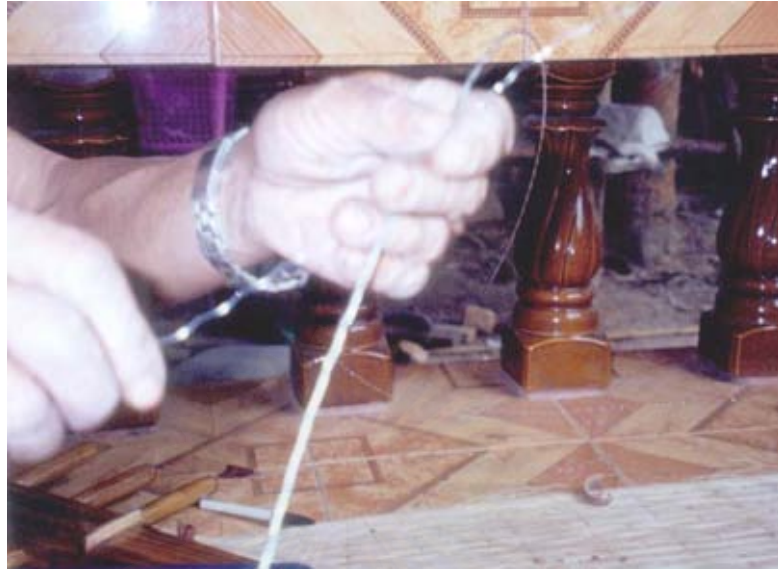
ภาพที่ 106 คลี่สายเบรคจักรยาน (สายโลหะ) ออกมาเป็นเส้นเดี่ยว
