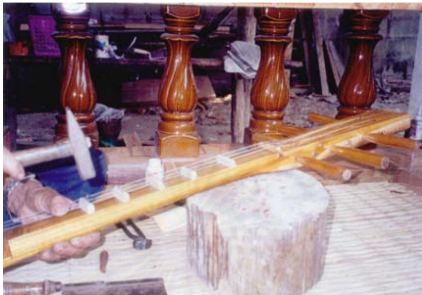
ภาพที่ 116 ติดลูกนับอันที่ 5
