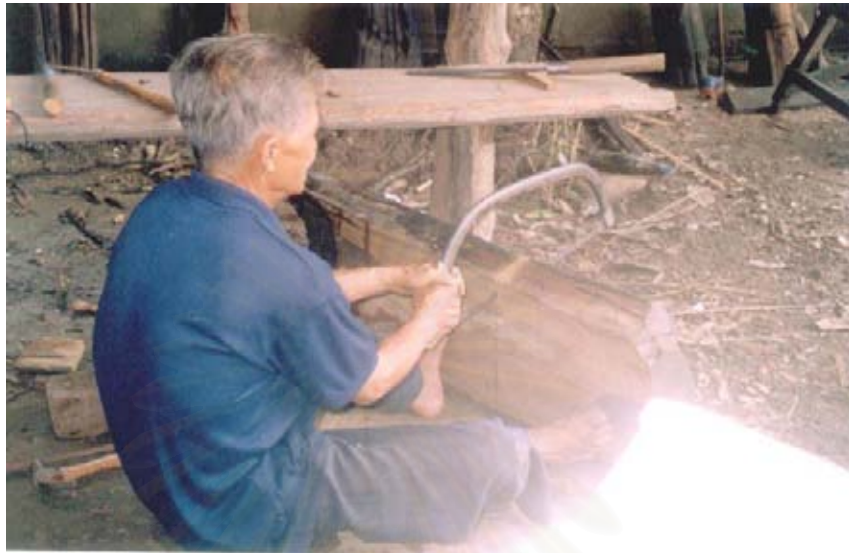
ภาพที่ 25 เลื่อยไม้เหนือจุดตัวกล่องเสียง
