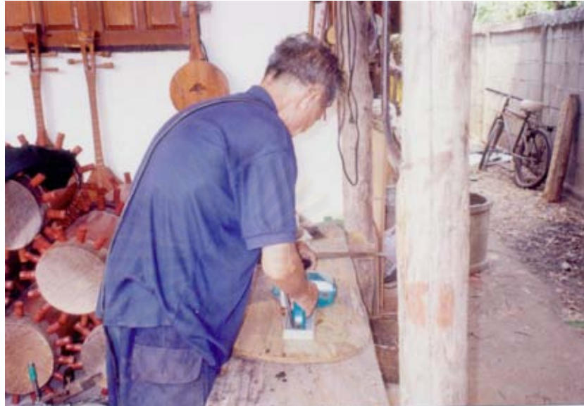
ภาพ 43 กบไฟฟ้าไล่ให้ความเรียบของตาไม้
