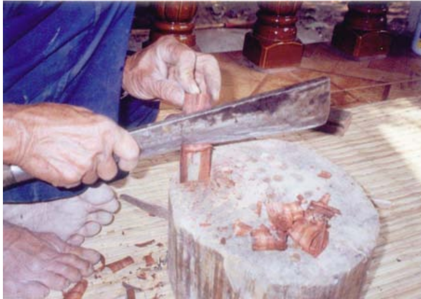
ภาพที่ 89 ใช้มีดถากทำที่ยึดสายซิ่ง
