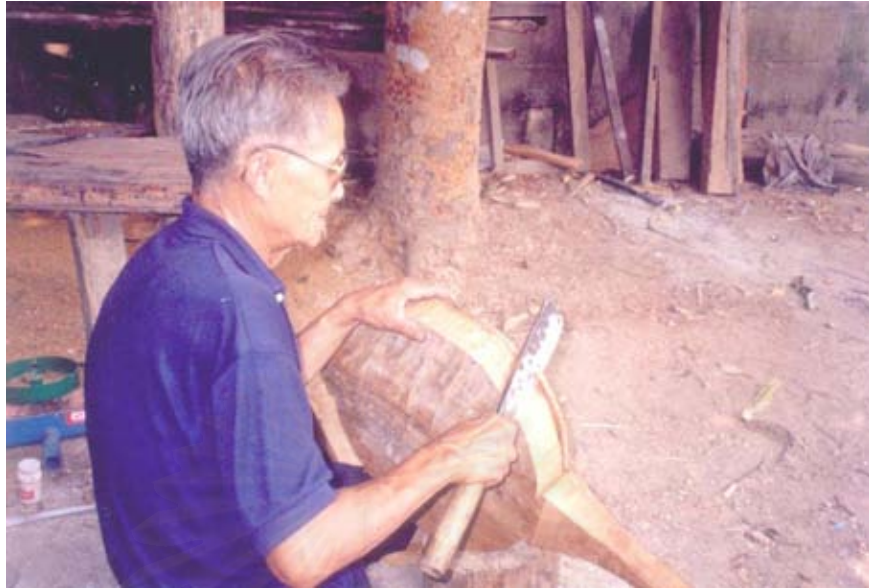
ภาพที่ 70 ถากส่วนที่เกินของตาดให้เท่ากับตัวกล่องเสียงซึ่ง 6 สาย ด้านบน
