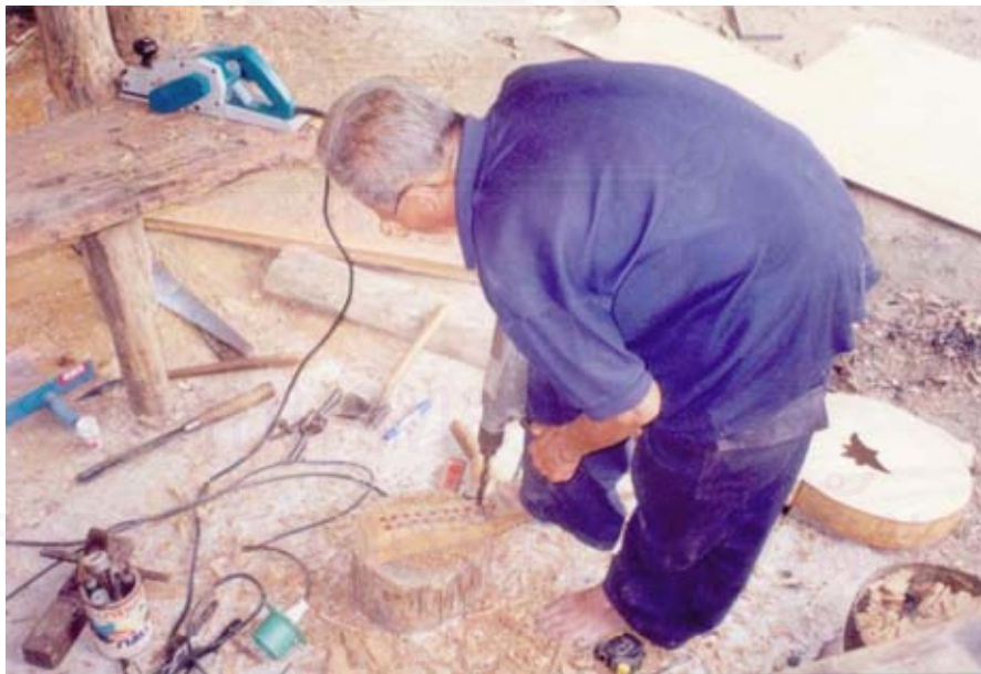
ภาพที่ 79 ใช้สว่านไฟฟ้าเจาะเป็นรูเรียงกันไว้
