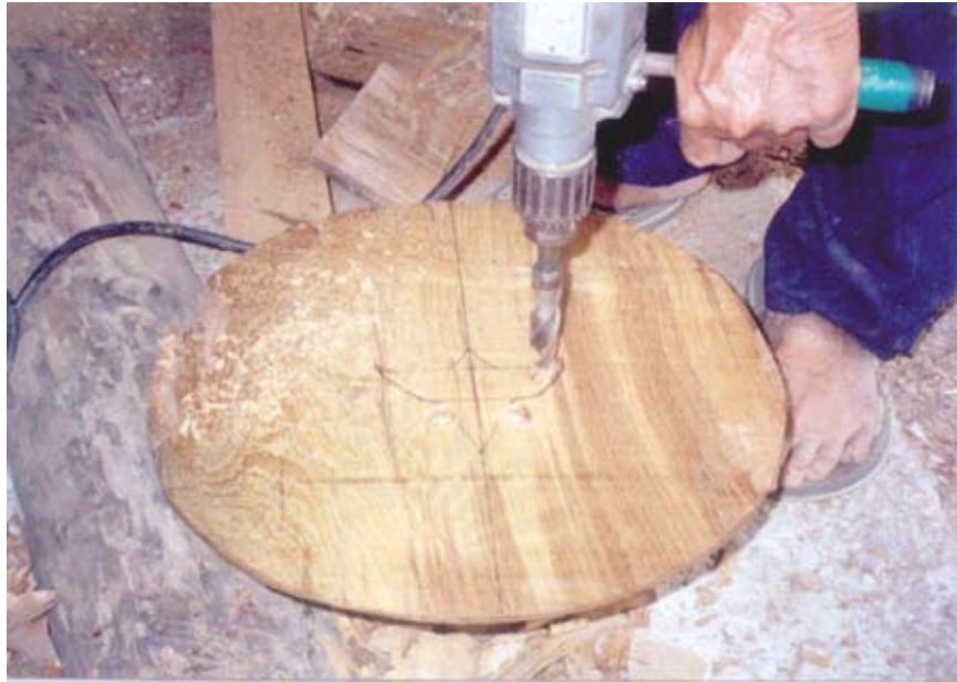
ภาพ 49 ใช้สว่านไฟฟ้าเจาะด้านปีก
