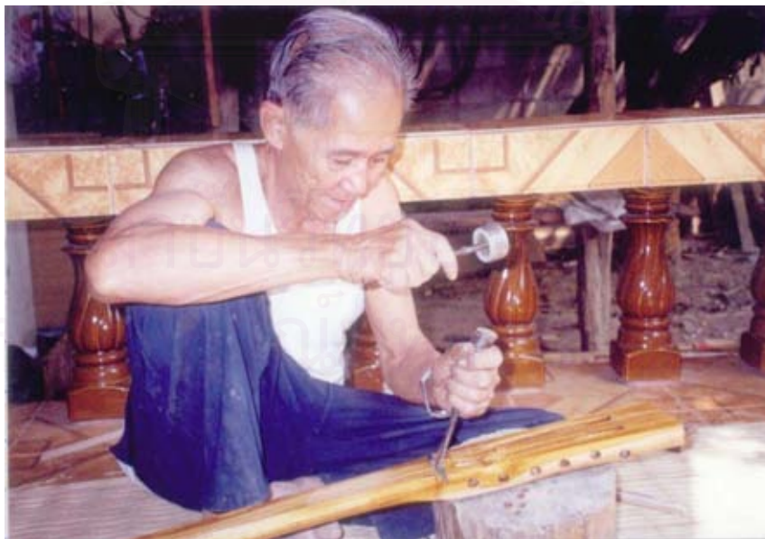
ภาพที่ 84 ใช้ค้อนขนาดเล็กตอกลิ่วในการทำก๊อบหน้า
