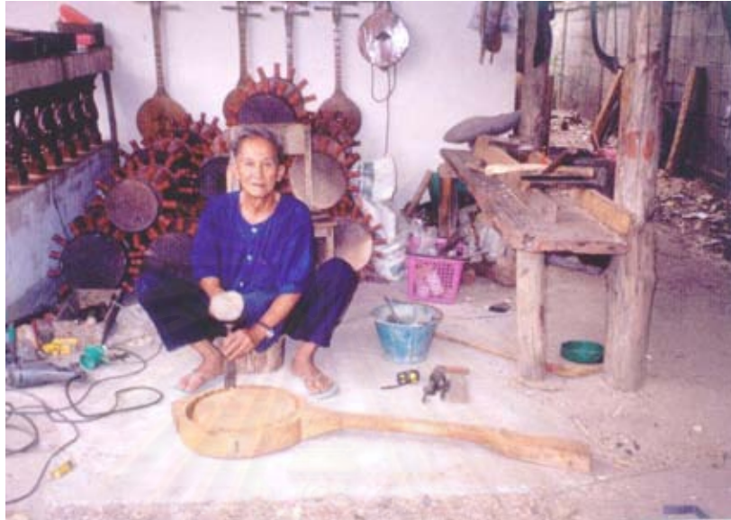
ภาพ 35 ขุดซึ่งด้วยค้อนไม้ทุบตีวงตัวกลองเสียงซิ่ง 6 สาย
