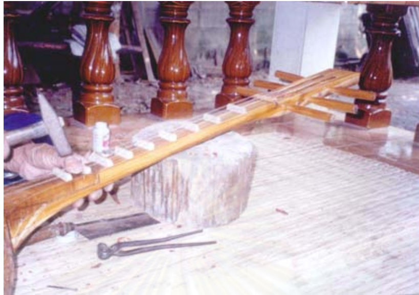
ภาพที่ 120 ติดลูกนับอันที่ 9
