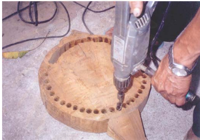
ภาพ 28 เเจาะตัวกล่องเสียงซึ่งด้วยส่วานไฟฟ้า
