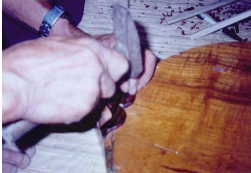
ภาพที่ 91 ใช้ค้อนตอกตะปูลงแผ่นไม้ยึดสายซิ่ง
