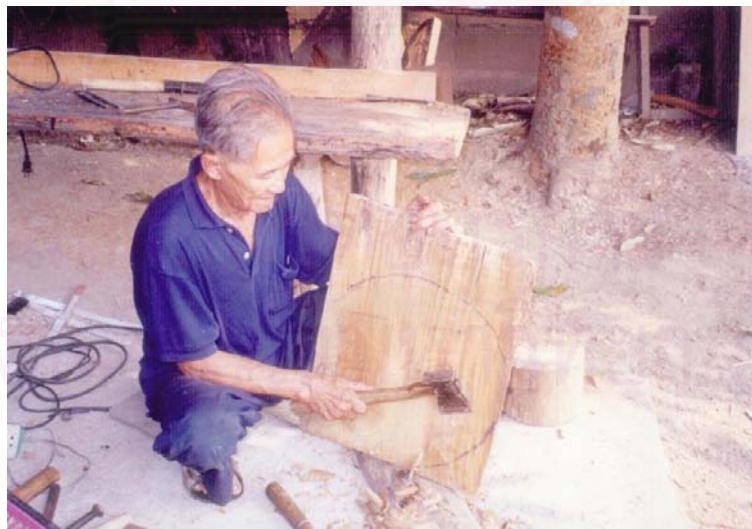
ภาพที่ 38 ใช้ขวานตากให้แผ่นไม้ตาดบางลง
