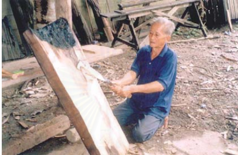
ภาพที่ 21 มีดถากด้านขวาของไม้
