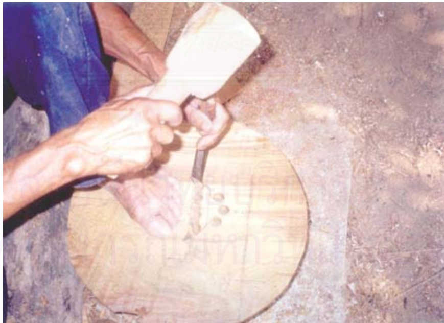
ภาพที่ 52 ใช้สิ่วหอบแต่งในส่วนที่เป็นปีก
