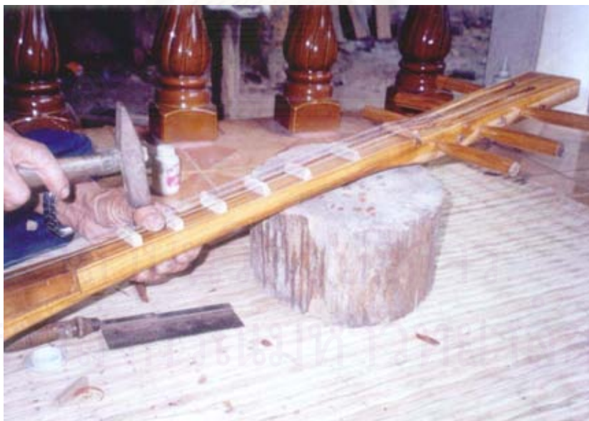
ภาพที่ 117 ติดลูกนับอันที่ 6
