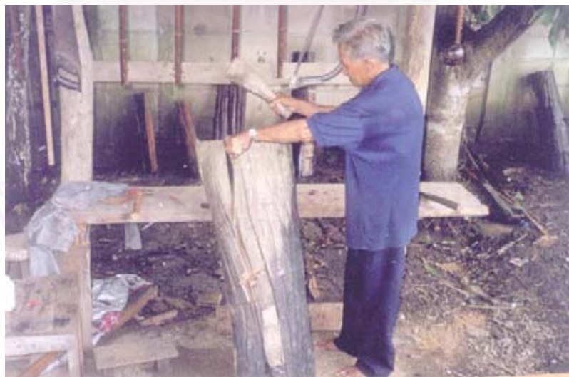
ภาพที่ 18 แปรรูปด้วยการใช้มีดและค้อนไม้ทูป
