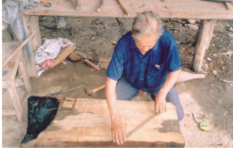
ภาพที่ 23 กำหนดจุดศูนย์กลางของตัวกล่องเสียง
