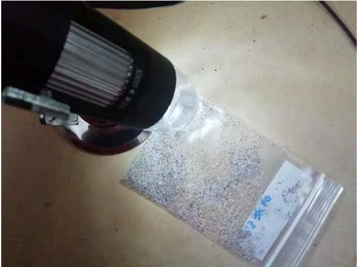
รูปที่ 13 การดูองค์ประกอบของตะกอนด้วยกล้องจุลทรรศน์
