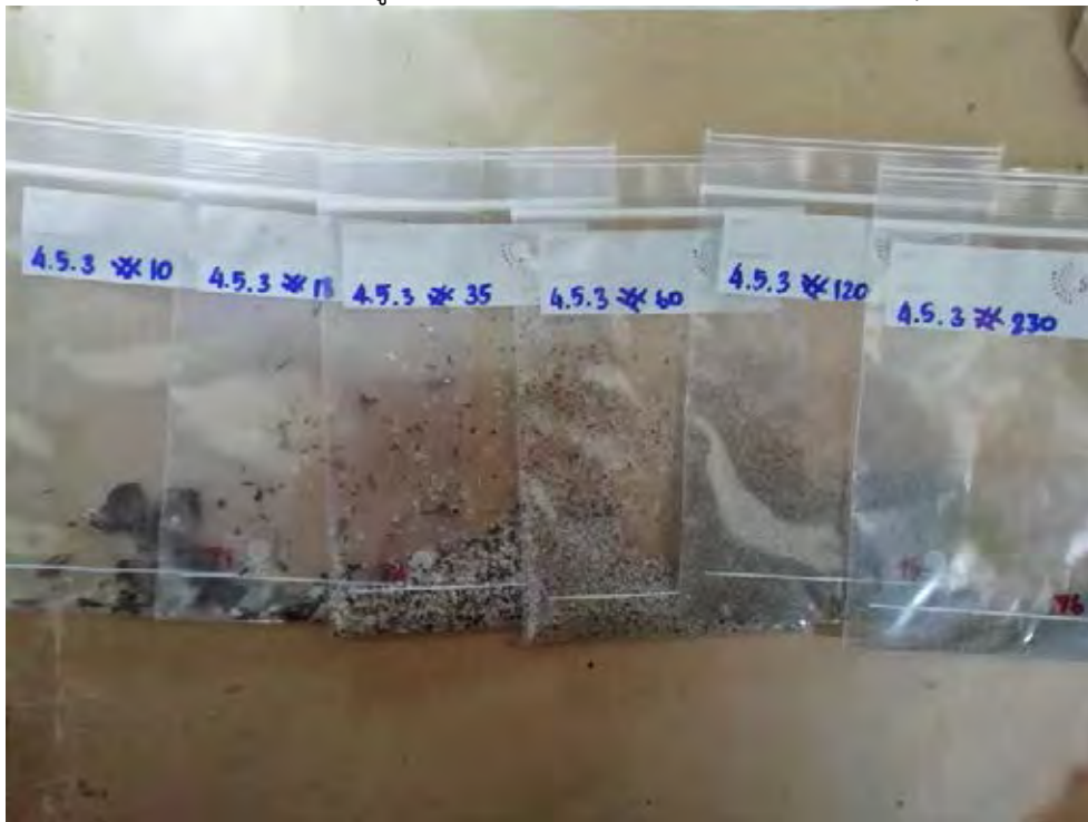
รูปที่ 12 ตะกอนของหลุมที่ 4.5 ชั้นที่ 3 ที่ได้จาก Sieve Analysis
