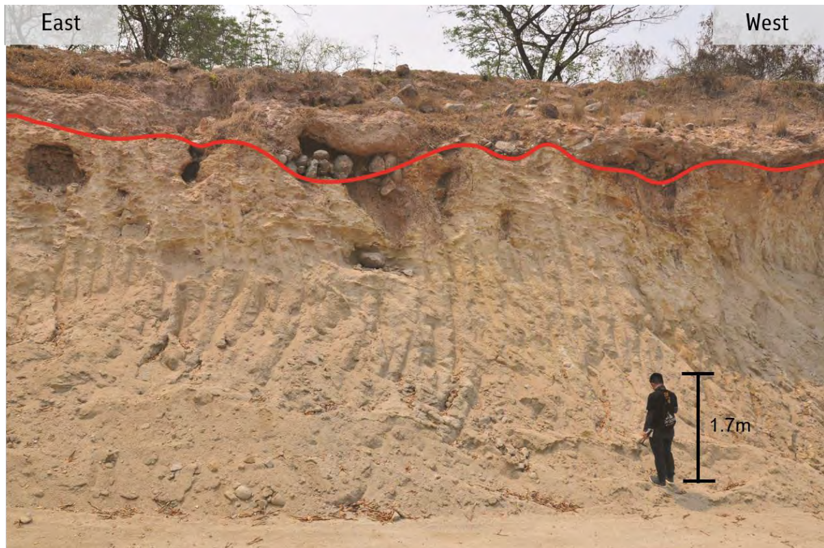
รูปที่ 5.18 แสดงหินโคลงที่มีชั้นตะกอนน้ำพาอยู่ส่วนบน (เหนือเส้นแดง) และหินแกรนิตที่มีการผุพังสูงในส่วนล่าง (ใต้เส้นแดง)
