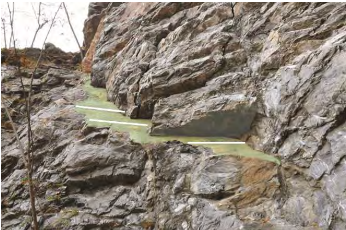
รูปที่ 5.8 ภาพหินโผล่แสดงรอยเลื่อนแนวระดับแบบซ้ายเข้า (เส้นประ) และรอยเลื่อนแบบย้อนที่ขนานกับระนาบของชั้นหินปูนในพื้นที่ (เส้นทึบ) (บน) และแสดงการวางตัวของระนาบรอยเลื่อนและรอยครูด (ล่าง)
