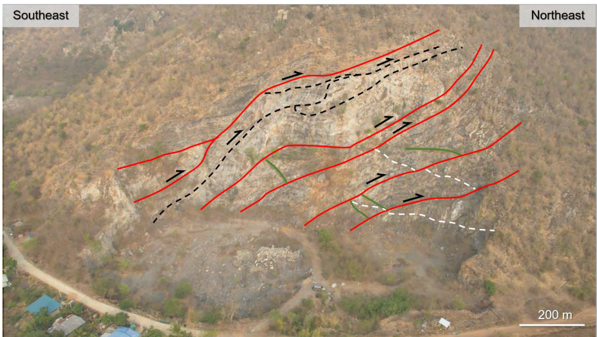
รูปที่ 5.7 ภาพหินโผล่เหมือนเขาลูกโกลนจากอากาศยานไร้คนขับ (Drone) (บน) และภาพแสดงธรณีวิทยาโครงสร้างของรอยเลื่อนย้อน (เส้นสีแดง) และหินอัคนีแทรกซอน (dike สีเขียว) (ล่าง)
