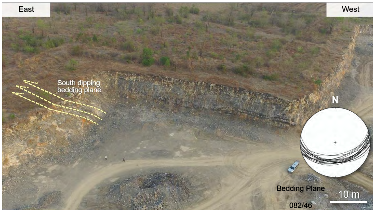
รูปที่ 5.2 ภาพหินโผล่เหมืองศิลาลานทองจากมุมสูง แสดงการเอียงเทไปทางใต้ (เส้นประสีเหลือง)
