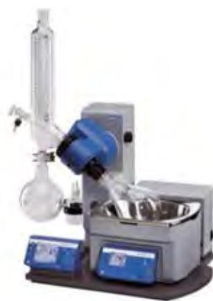
รูปที่ 3.3 เครื่องระเหยแบบหมุน (Rotary evaporator) [15]
