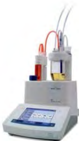
รูปที่ 3.7 เครื่องวิเคราะห์หาปริมาณน้ำในน้ำมันดิบชีวภาพ (Karl-Fischer Titration) [17]
