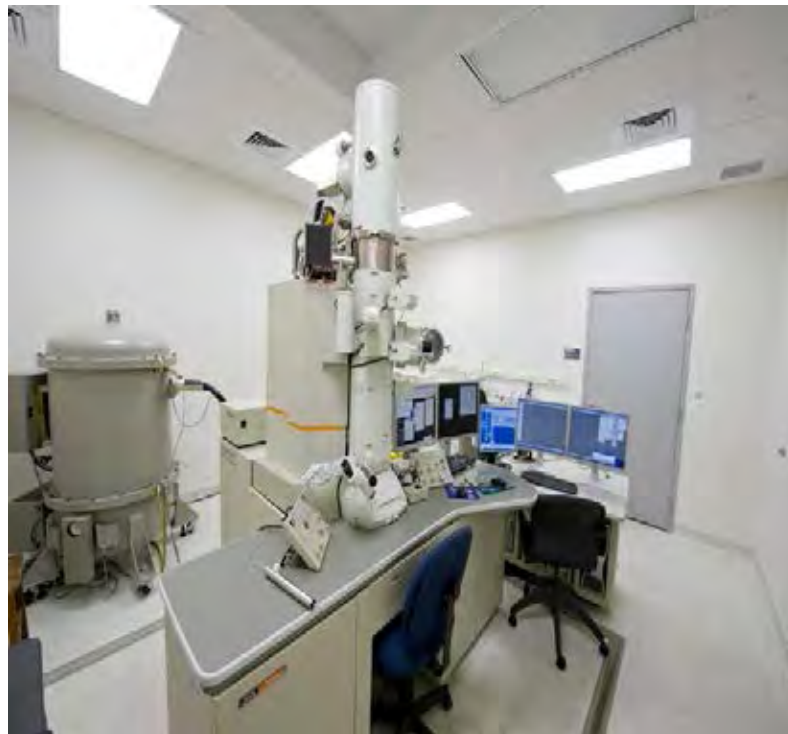
รูปที่ S2 กล้องจุลทรรศน์อิเล็กตรอนแบบส่องผ่าน (Transmission Electron Microscope : TEM) รุ่น JEM-2100/HR (200 kV) (ที่มา : http://www.nano.pitt.edu/node/488 )
