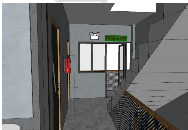
ภาพที่ 7.11 แสดงการติดตั้งระบบความปลอดภัยเพิ่มเติมพื้นที่ส่วนกลาง
