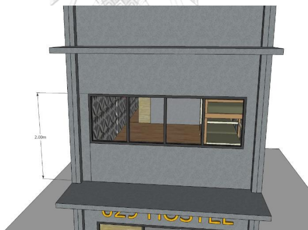
ภาพที่ 7.7 แสดงระยะความสูงของช่องแสงต้องไม่ต่ำกว่า 1.80 เมตร
