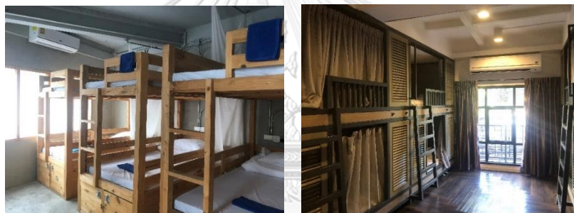
ภาพที่ 6.10 ขนาดห้องพักที่มีขนาดพื้นที่มากกว่าหรือเท่ากับ 8 ตารางเมตร และมีความสูงจากพื้นถึงเพดานที่ 2.6 เมตร ตรงตามข้อกำหนดกำหนด
