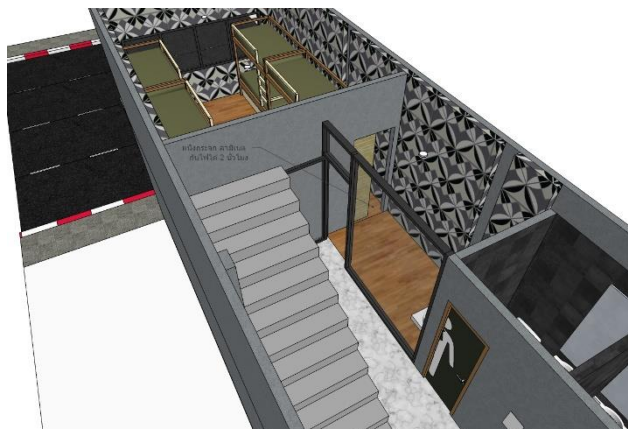
ภาพที่ 7.10 แสดงการปิดล้อมพื้นที่บริเวณบันไดหลักที่ใช้เป็นบันไดหนีไฟภายในอาคาร
