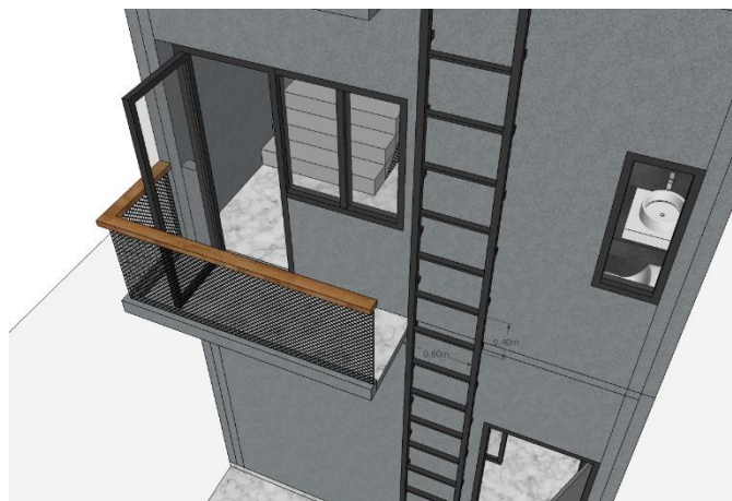
ภาพที่ 7.4 แสดงการติดตั้งบันไดลิงที่ใช้เป็นบันไดหนีไฟภายนอก
