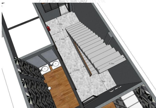
ภาพที่ 7.9 แสดงขนาดความกว้างของทางเดินภายในและบันไดหลัก สำหรับอาคารที่สูงเกิน 2 ชั้น ที่มา : ผู้วิจัย
