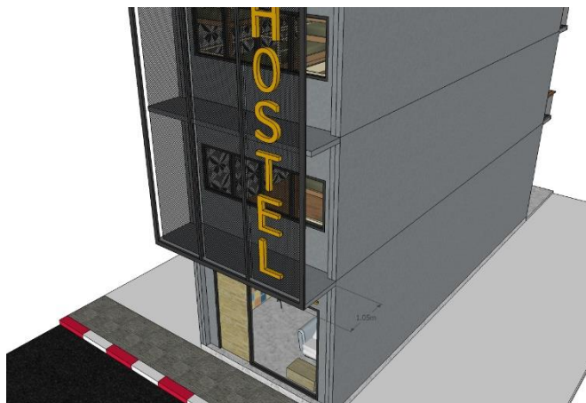
ภาพที่ 7.6 แสดงการติดตั้งวัสดุตกแต่งเปลือกอาคาร
