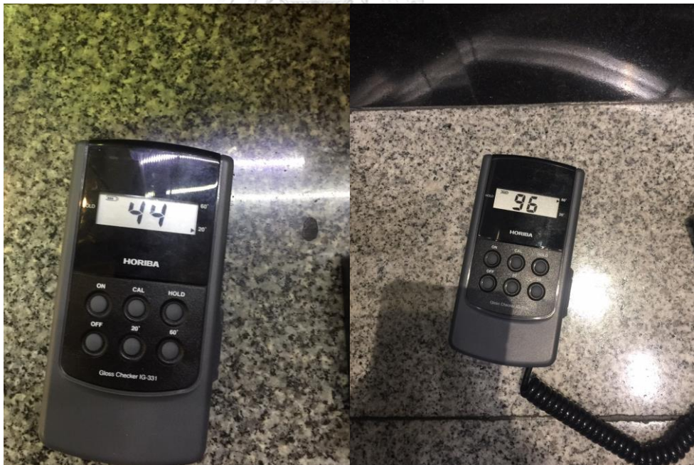
ภาพที่ 7.23 การตรวจวัดค่าความเงาของผิวกระเบื้อง
