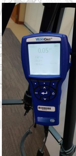
ภาพที่ 4.13 อุปกรณ์ตรวจวัดคุณภาพอากาศภายในอาคาร (ที่มา : จากการสำรวจของผู้วิจัย)
