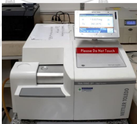
รูปที่ 3.11 เครื่องวิเคราะห์น้ำหนักภายใต้ความร้อน (ทีจีเอ)
