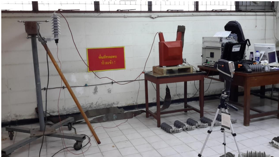
รูปที่ 3.3 การตรวจวัดกระแสรั่วของกับดักเสิร์จ
