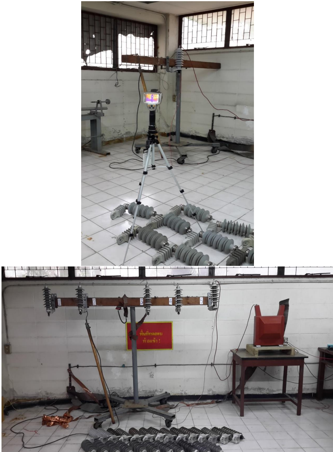
รูปที่ 4.4 วิธีการติดตั้งกับดักเสิร์จเพื่อทดลองการวัดอุณหภูมิด้วยกล้องส่องความร้อนอินฟราเรด
