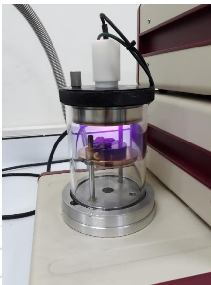
รูปที่ 3.28 การเคลือบอนุภาคทองคำก่อนทดสอบกล้องจุลทรรศน์อิเล็กตรอน
