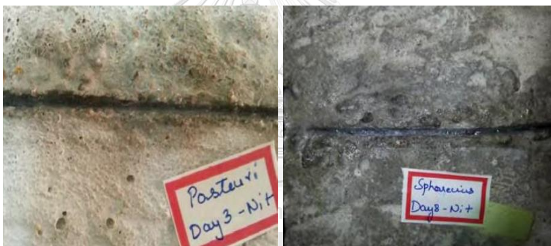
รูปที่ 2.32 การหมักนมรยร้าวโดยใช้แบคทีเรียชนิด Bacillus pasteurii และ Bacillus sphaericus
