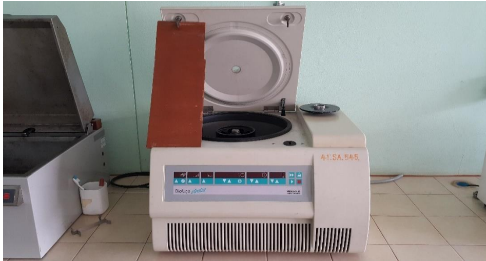
รูปที่ 3.14 เครื่องปั่นเหวี่ยงตกตะกอนความเร็วสูง (Microcentrifuge)
