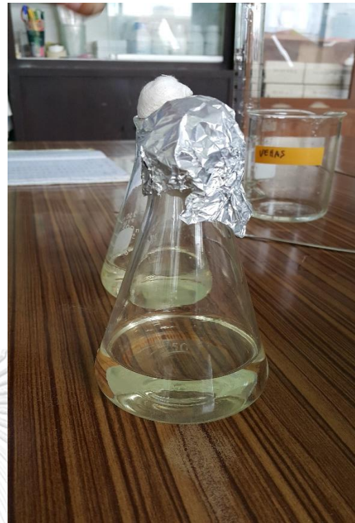
รูปที่ 3.19 รูป (ก) ส่วนประกอบของสารอาหารเหลวสำหรับการเลี้ยงเชื้อจุลินทรีย์ และรูป (ข) หลังจากเติมน้ำกลั่นปริมาณ 100 มิลลิลิตร และคนให้เข้ากัน
