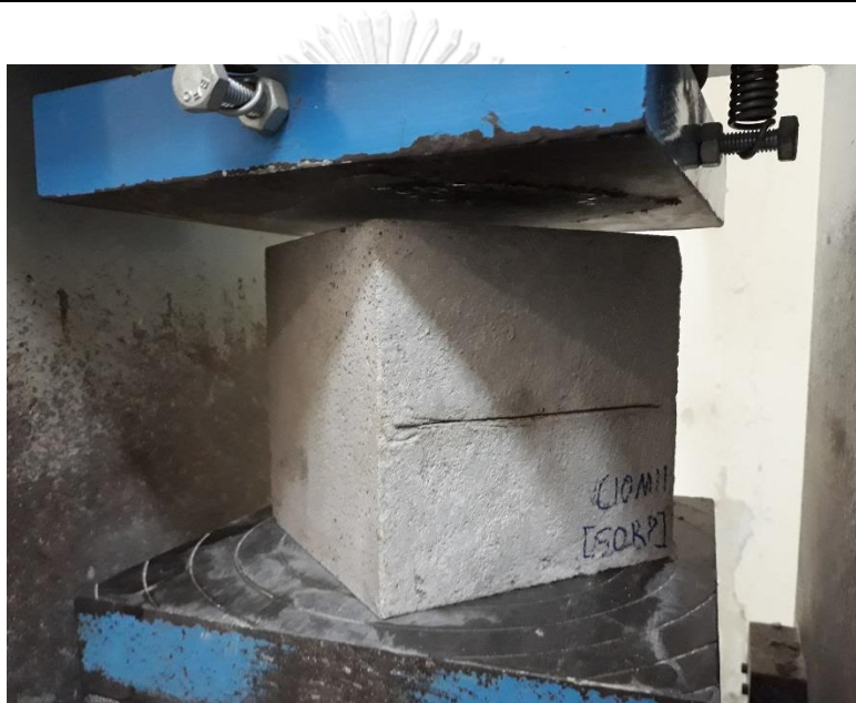
รูปที่ 4.7 การทดสอบกำลังรับแรงอัดสำหรับตัวอย่างแบบมีรอยร้าว ของตัวอย่าง C1 ในกลุ่มที่ 2
