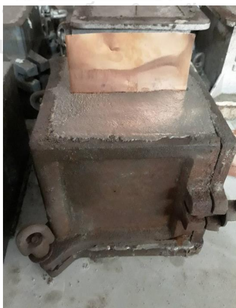
รูปที่ 3.11 การติดตั้งแผ่นทองแดงเพื่อทำการสร้างรอยร้าว
