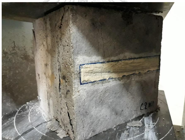
รูปที่ 4.8 การทดสอบกำลังรับแรงอัดหลังการซ่อมแซม ของตัวอย่าง C2 ในกลุ่มที่ 3
