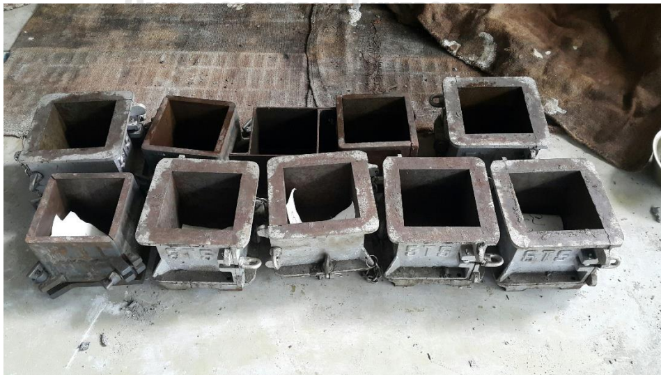
รูปที่ 3.7 แบบหล่อตัวอย่างขนาด 15 x 15 x 15 เซนติเมตร
