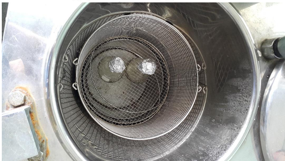
รูปที่ 3.20 การนำอาหารเหลวไปทำการฆ่าเชื้อภายในเครื่องนึ่งฆ่าเชื้อ
