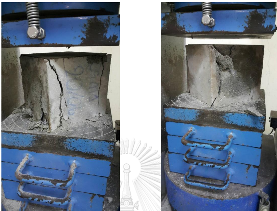
รูปที่ 4.6 สภาพตัวอย่างแบบไม่มีรอยร้าวหลังผ่านการทดสอบกำลังรับแรงอัด ของตัวอย่าง C2 ใน กลุ่มที่ 1
