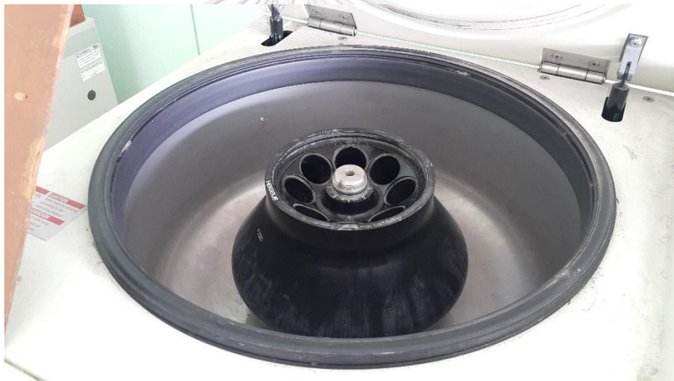
รูปที่ 3.15 ภายในเครื่องปั่นเหวี่ยงตกตะกอนความเร็วสูง (Microcentrifuge)
