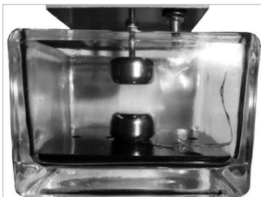
รูปที่ 3.4 การจัดวางระบบอิเล็กทรอนิกส์แบบระนาบขนานกันในโถแก้วทรงสี่เหลี่ยม.
