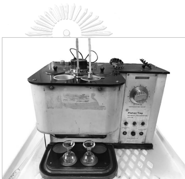
จุฬาลงกรณ์มหาวิทยาลัย รูปที่ ก 1. เครื่องวัดความหนืด
