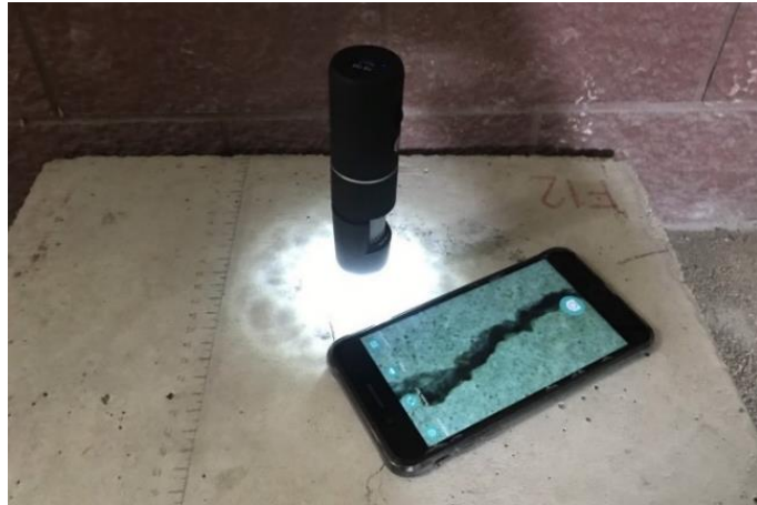
รูปที่ 4.8 การหาความกว้างของรอยร้าวที่เกิดขึ้นจริงของตัวอย่างก้อนคอนกรีตเสริมเหล็ก ด้วยกล้องจุลทรรศน์ดิจิทัล
