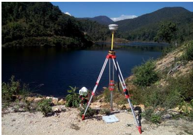
รูปที่ 8 แสดงวิธีการรังวัดแบบสถิต
