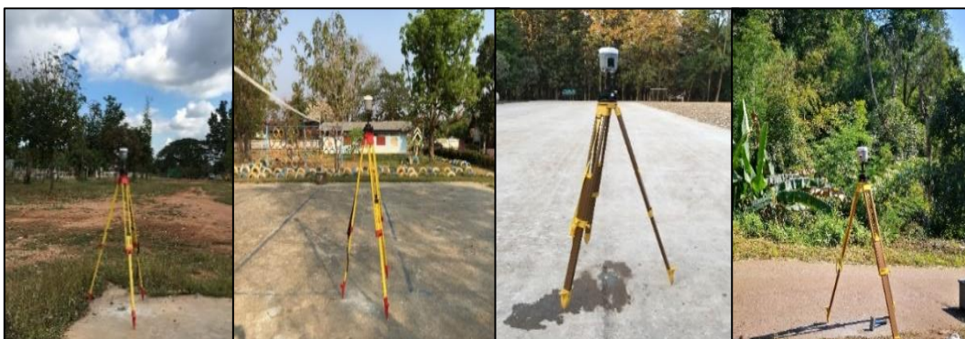
ภาพที่ 4 ตัวอย่างการรังวัดสัญญาณดาวเทียมจีเอ็นเอสเอสของหมุดทดสอบในพื้นที่ต่างๆ
