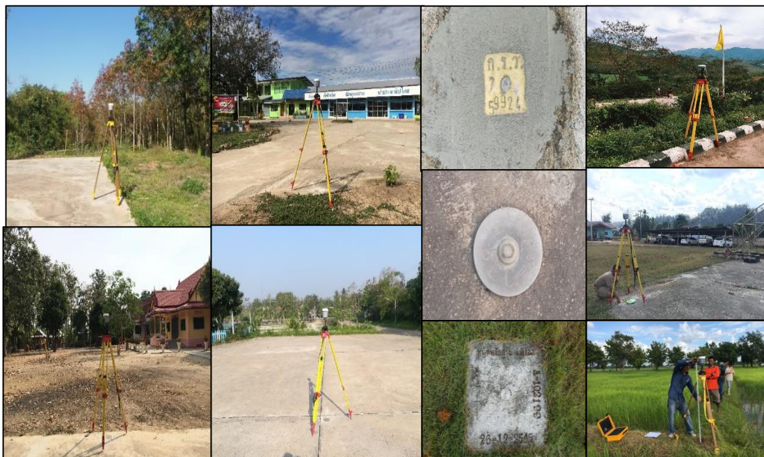
ภาพที่ 18 ตัวอย่างวิธีการรังวัดสัญญาณจีเอ็นเอสที่ใช้ในการศึกษาวิจัยในพื้นที่ต่างๆ
