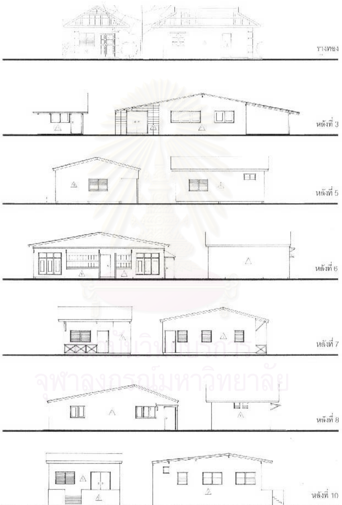
ภาพประกอบที่ 5.6 : แสดงการเปรียบเทียบรูปทรงของหลังคาของบ้านที่เปลี่ยนแปลงแบบ กับแบบ “รางทอง”
