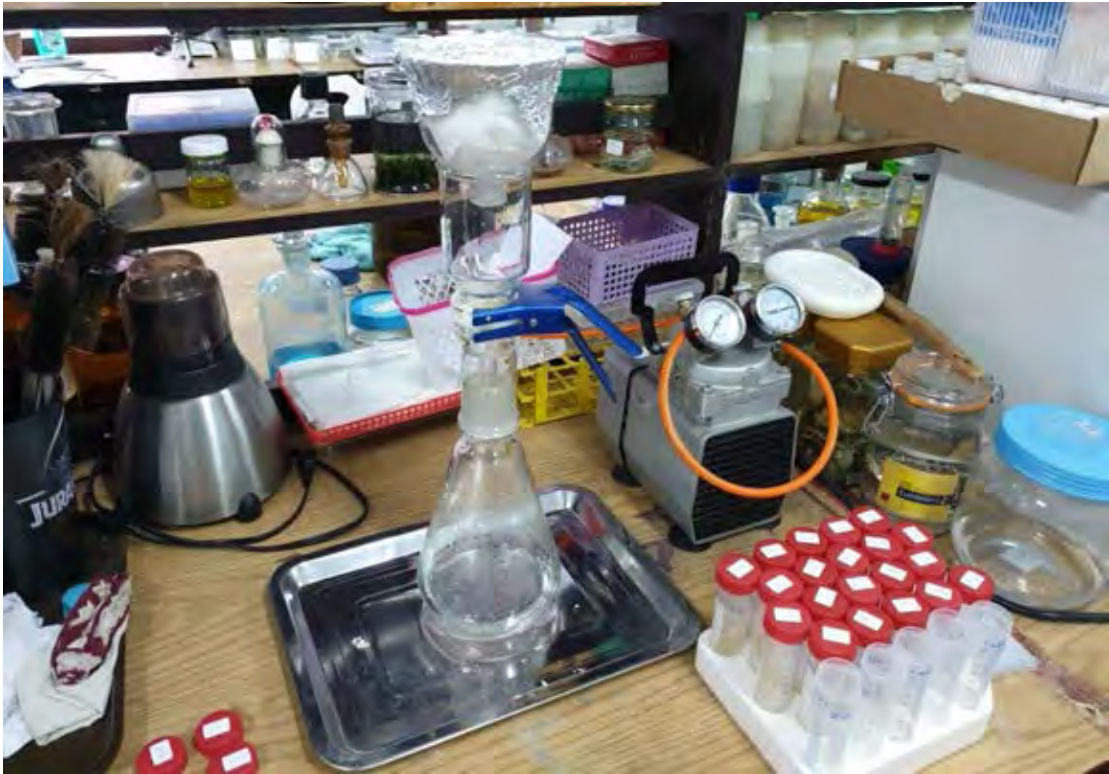
ภาพที่ 3.13 กรองสารแขวนลอยผ่านเครื่องกรองสุญญากาศโดยใช้กระดาษกรอง Whatman 1.2 micrometers เพื่อแยกอนุภาคต่าง ๆ ออกจากสารแขวนลอย
