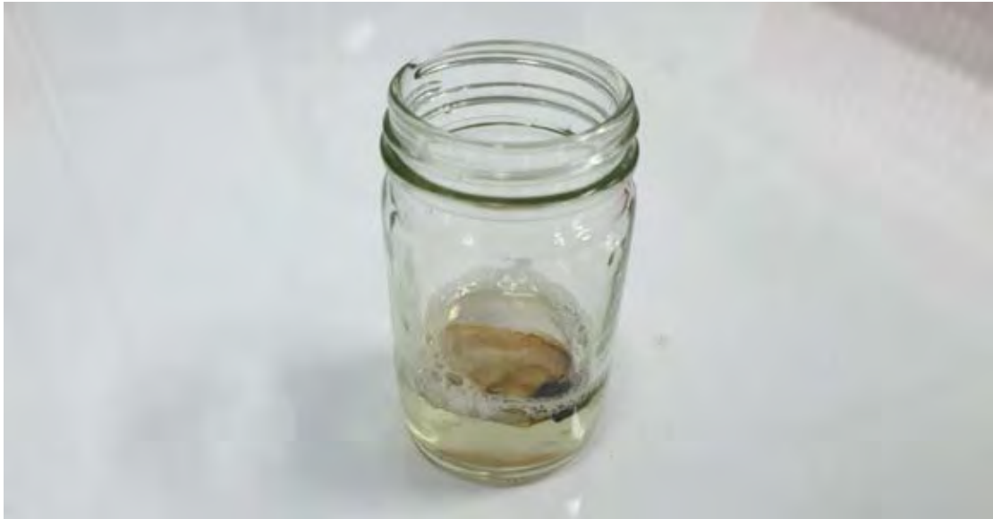
ภาพที่ 3.11 การย่อยหอยนางรมด้วยสารละลายโพแทสเซียมไฮดรอกไซด์ 10%
