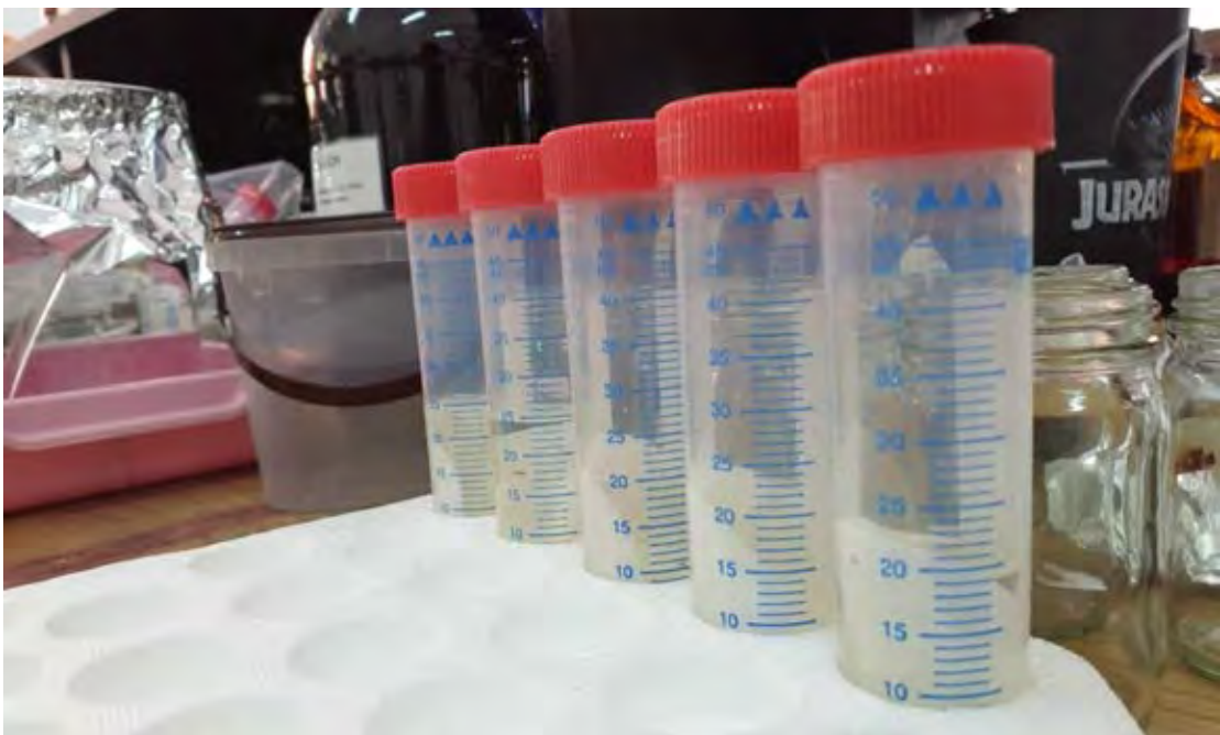
ภาพที่ 3.14 แผ่นกรอง Whatman 1.2 micrometers ในหลอดทดลองที่มีสารละลายโซเดียมไฮดรอกไซด์ 4.4 M ปริมาตร 15 มิลลิลิตร เพื่อใช้แยกไมโครพลาสติกออกจากอนุภาคอื่น ๆ
