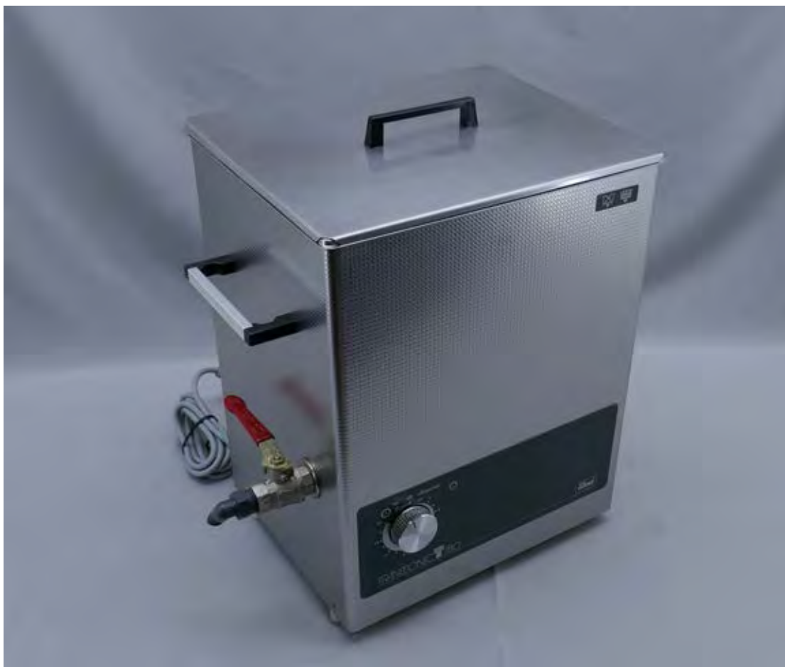
ภาพที่ 3.15 เครื่อง soniction ELMA - Transsonic T-780 ใช้เพื่อทำให้ไมโครพลาสติก และอนุภาคธรรมชาติจากหอยนางรมหลุดออกจากแผ่นกรอง (ที่มา: https://www.ebay.de/itm/Elma-Transsonic-T780-Ultraschallreiniger/173765969806 )
