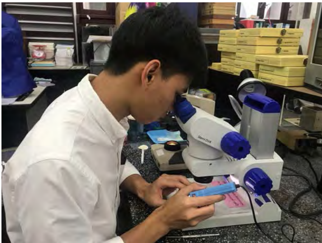
ภาพที่ 3.16 การตรวจสอบและระบุชนิดไมโครพลาสติกของหอยนางรมบนแผ่นกรอง Whatman 1.2 micrometers ด้วยหัวเร่งและกล้องจุลทรรศน์
