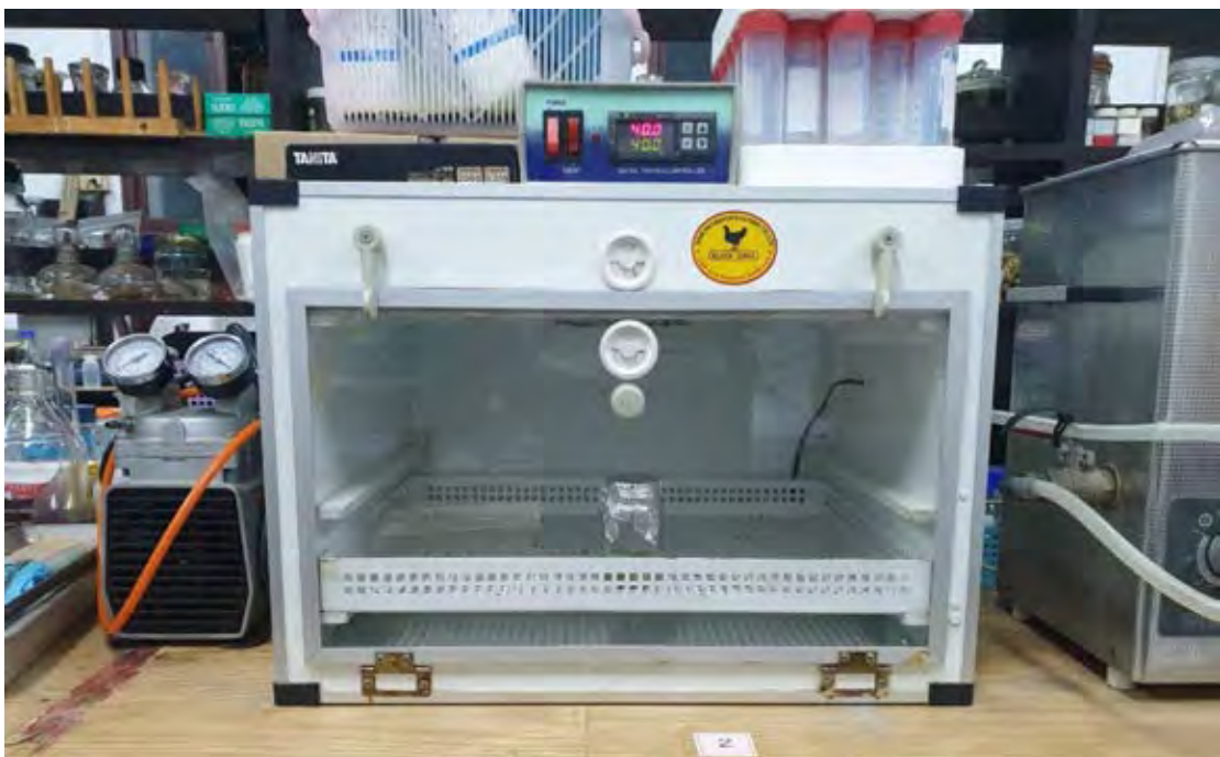
ภาพที่ 3.12 ตู้บสำหรับอุ่นสารละลายและหอยนางรมที่อุณหภูมิ 40°C เป็นเวลา 72 ชั่วโมง
