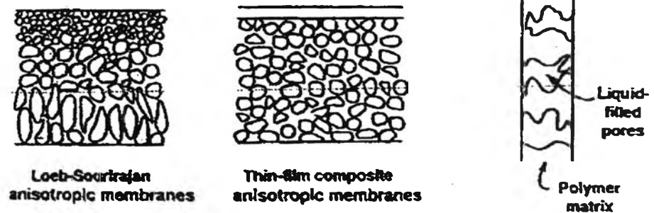
รูปที่ 2.9 การแบ่งประเภทของเมมเบรนตามโครงสร้างของเมมเบรน (Baker, 2000)
