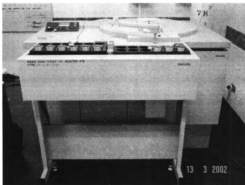
รูปที่ 3.3 เครื่องวิเคราะห์ระบบ WDX Philips PW2400 และเครื่องเปลี่ยนตัวอย่าง
