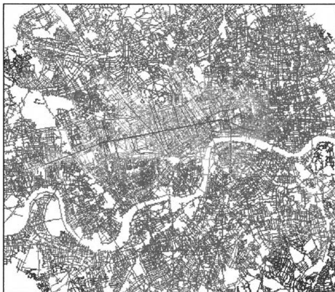
รูป 2.28 การวิเคราะห์ศักยภาพในการเข้าถึงระดับพื้นที่เมือง (global integration analysis) ของเส้นทางต่าง ๆ ในโครงข่ายการสัญจร (spatial grid network) ของเมืองลอนดอน ด้วยโปรแกรม Space Syntax (Hillier, 1996 อ้างถึงใน ไชศรี ภักดิ์สุขเจริญ, 2548)
