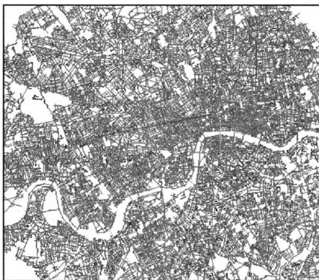
รูป 2.29 การวิเคราะห์ศักยภาพในการเข้าถึงระดับพื้นที่เฉพาะ (local integration analysis) ของเส้นทางต่าง ๆ ในโครงข่ายการสัญจร (spatial grid network) ของเมืองลอนดอน ด้วยโปรแกรม Space Syntax (Hillier, 1996 อ้างถึงใน ไชศรี ภักดิ์สุขเจริญ, 2548)
