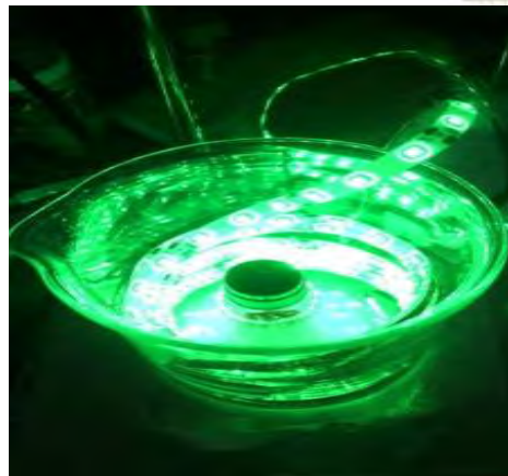
รูปที่ 12ก การพัน LED สีต่างๆ ในปีกเกอร์เพื่อใช้เป็นแหล่งกำเนิดแสง
