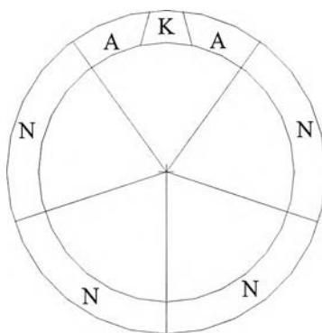
รูปที่ 2.2 หน้าตัดควดคู่อินทรีย์ประกอบของชิ้นส่วนควดคู่อินทรีย์ใน 1 วง
