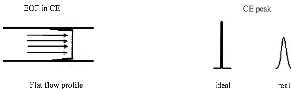
รูปที่ 2.3 ลักษณะการไหลของสารและรูปร่างของพีคใน CE: ดัดแปลงจาก [Li, 1992]
