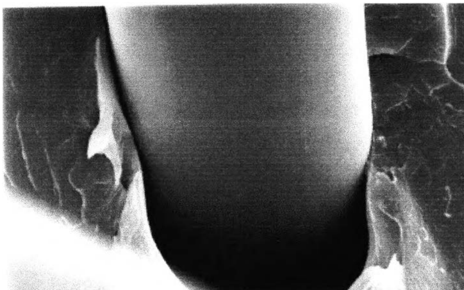
รูปที่ 5.27 ภาพถ่าย SEM ผิวนุ่นใยที่ยังไม่ผ่านการปรับแต่งผิว (กำลังขยาย 2,000 เท่า)
