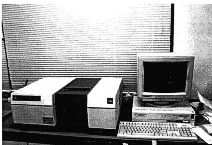
รูปที่ 3.2 ฟูเรียร์ทรานสฟอร์มอินฟราเรดสเปกโทรโฟโตมิเตอร์
