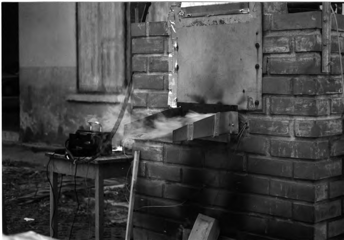
รูปที่ 6.14 (ต่อ) แสดงภาพถ่ายเปลวไฟที่ลุกไหม้ออกมาจากช่องป้อนเชื้อเพลิง
