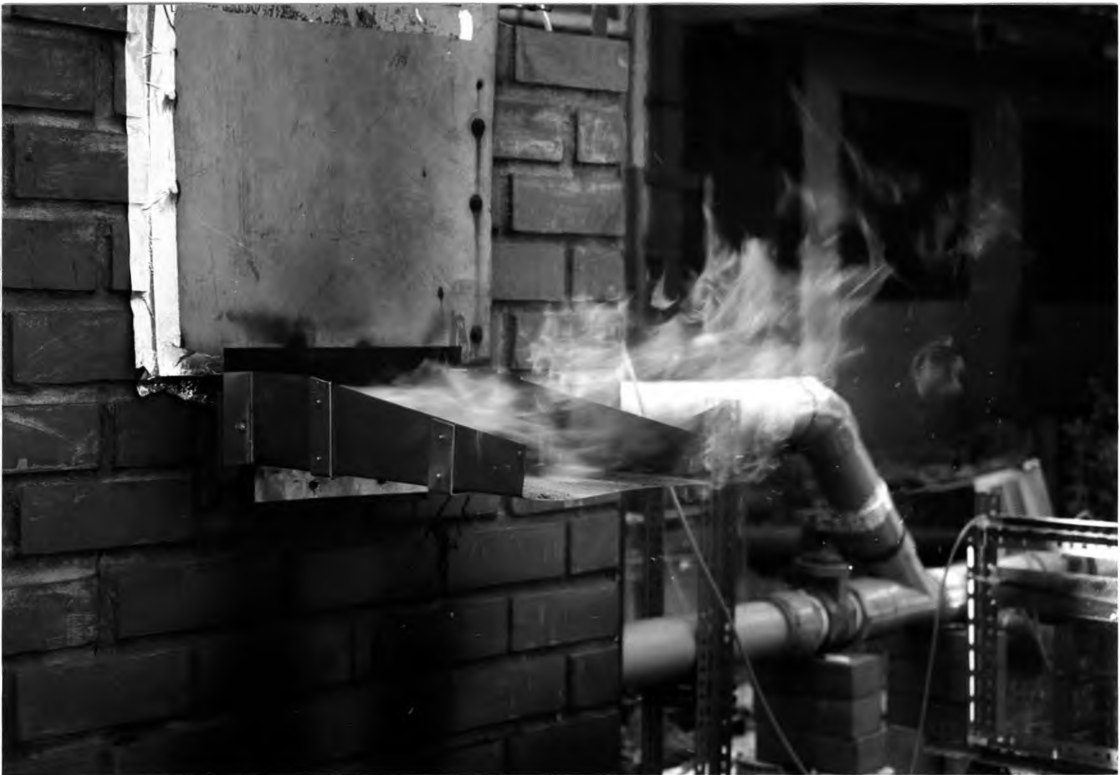
รูปที่ 6.14 แสดงภาพถ่ายเปลวไฟที่ลุกไหม้ออกมาจากช่องป้อนเชื้อเพลิง
