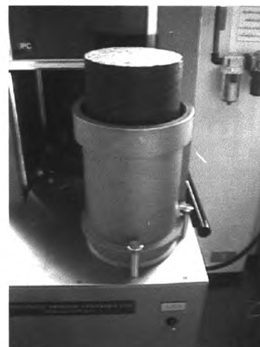
รูปที่ ข-4 ตัวอย่างที่คั่นออกจากแบบหล่อหลังจากบดอัดเสร็จแล้ว
