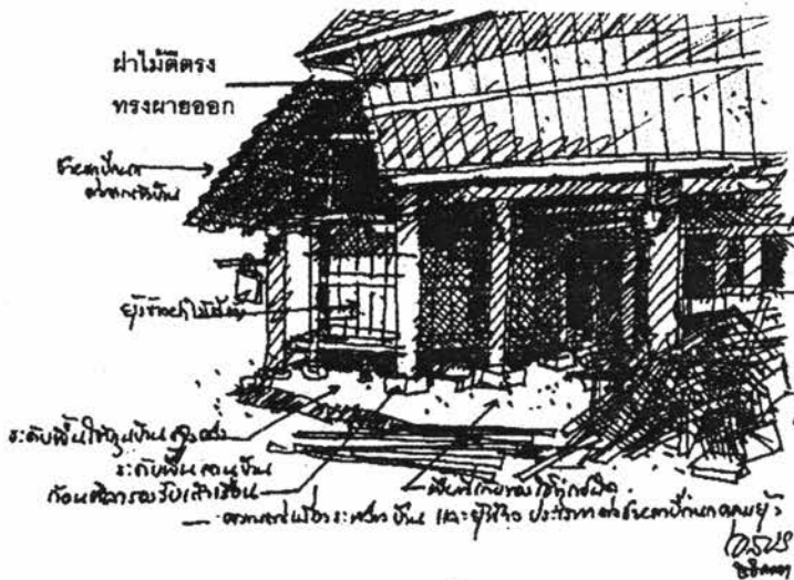
รูปที่ 2.19 ภาพลายเส้นแสดงถึงผนังผายของบ้านชาวไตลื้อ สิบสองพันนา (อรศิริ ปาณินท์, 2539: 51)
